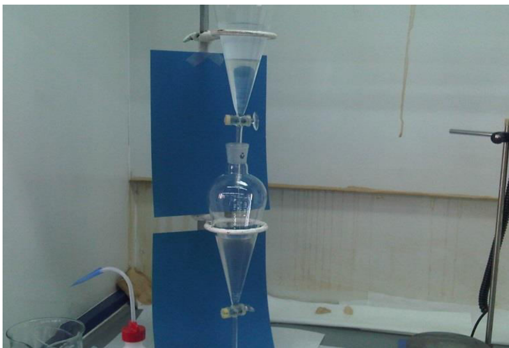
Εικόνα 4.5: Πειραματική διάταξη διαχωρισμού των δύο υγρών φάσεων, με την βοήθεια διαχωριστικής χοάνης
