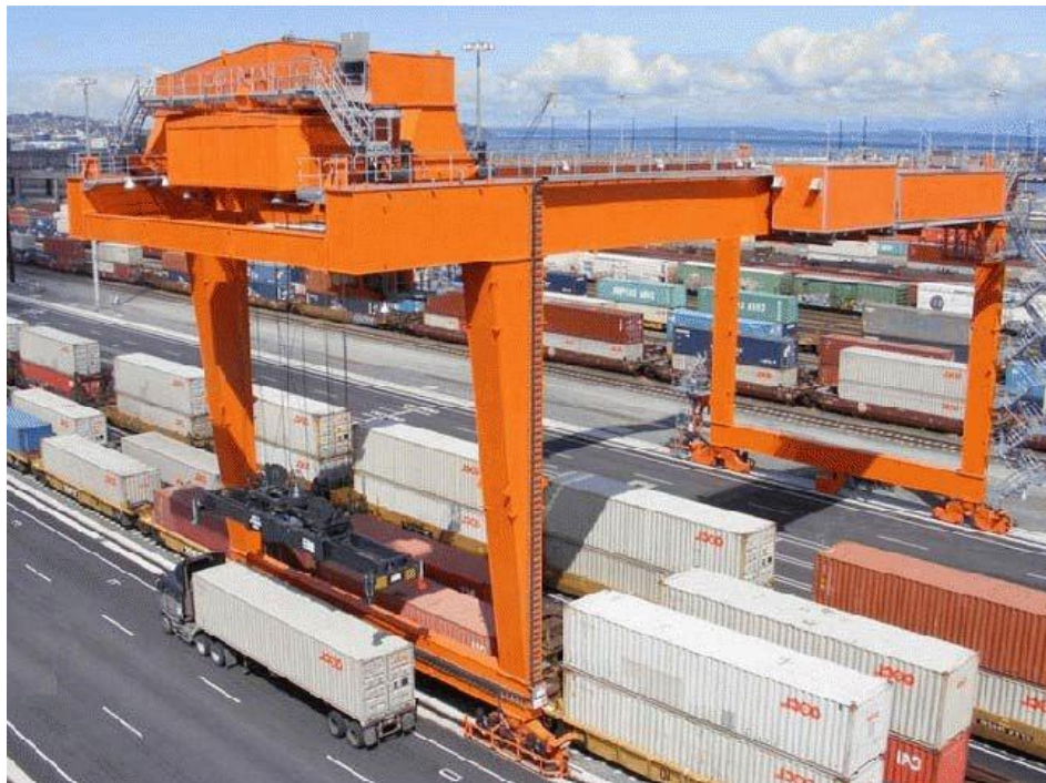
Εικόνα 3: Γερανογέφυρα σε σιδηροτροχιές
