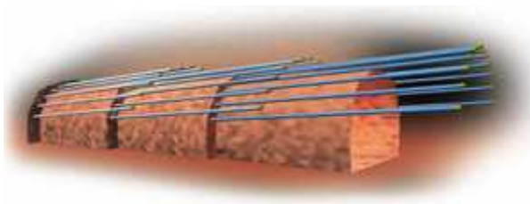
Εικόνα 1.2.1: Απεικόνιση τοποθέτησης δοκών προπορείας
