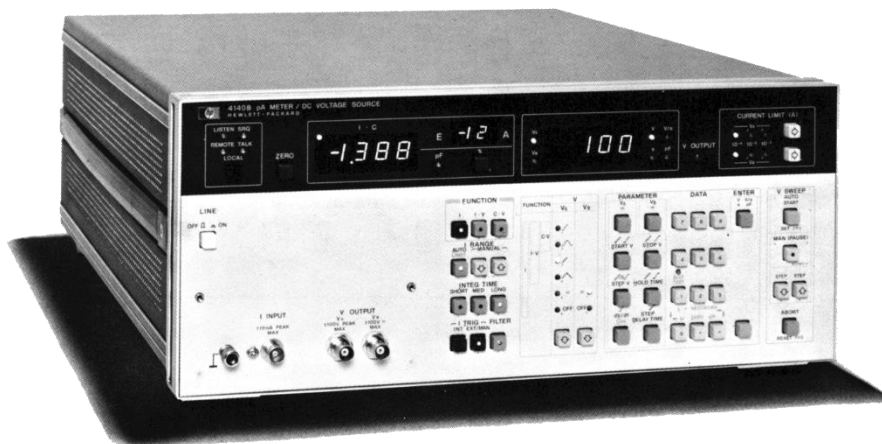
Εικόνα 6.1 - Το pico-αμπερόμετρο και τροφοδοτικό DC τάσης της Hewlett Packard 4140B
