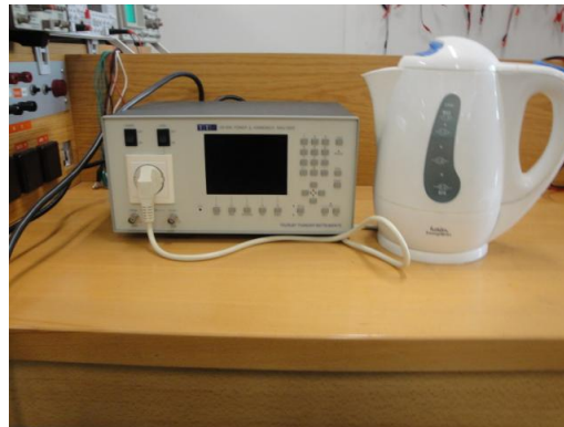
Εικόνα 2.27: Ο βραστήρας συνδεδεμένος στο Power Analyser HA-1600.
