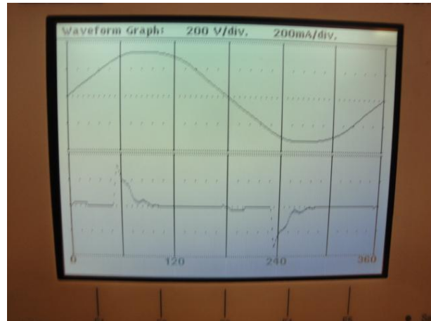
Εικόνα 2.6: Η κυματομορφή της τάσης και του ρεύματος.
