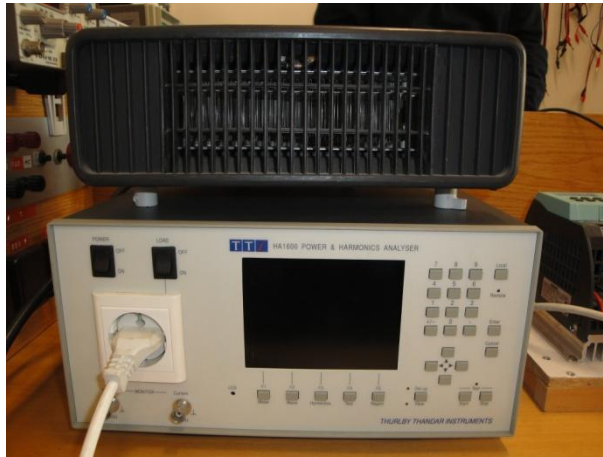
Εικόνα 2.39: Το αερόθερμο πριν από την έναρξη της μέτρησης.
