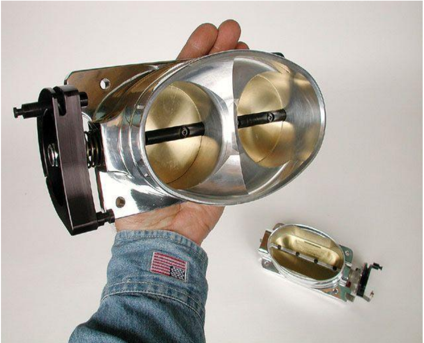
Σχήμα 1.21: Διπλοί δίσκοι πεταλούδας ή και μονός δίσκος πεταλούδας μεγάλων διαστάσεων, για περιπτώσεις κινητήρων υψηλού κυβισμού και επιδόσεων όπως η cobra mustang, της οποίας οι δίσκοι της “πεταλούδας” (throttle plates) απεικονίζονται εδώ [25].
