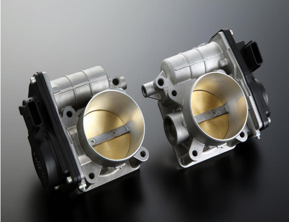
Σχήμα 1.5: “Μπλοκ” “πεταλούδας” ηλεκτρονικής σύνδεσης με το “πεντάλ”. Είναι φανερό η ύπαρξη ηλεκτροκινητήρα και η καλυμμένη διάταξη μειωτήρα για μεταφορά της κίνησης από το μοτέρ στον άξονα της “πεταλούδας” [11].
