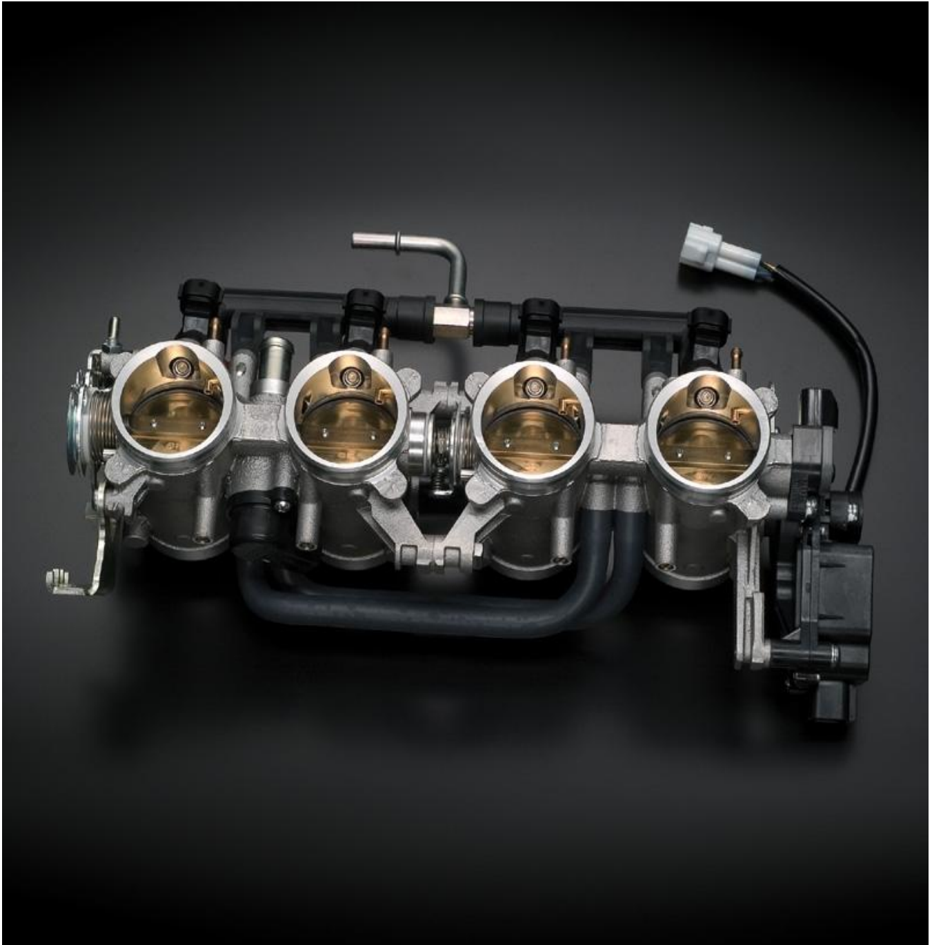
Σχήμα 1.18: Αυτόνομα “μπλοκ” “πεταλούδας” ( ITB’s) μιας SUZUKI GSXR750cc του τετράχρονου τετρακύλινδρου κινητήρα της [22].
