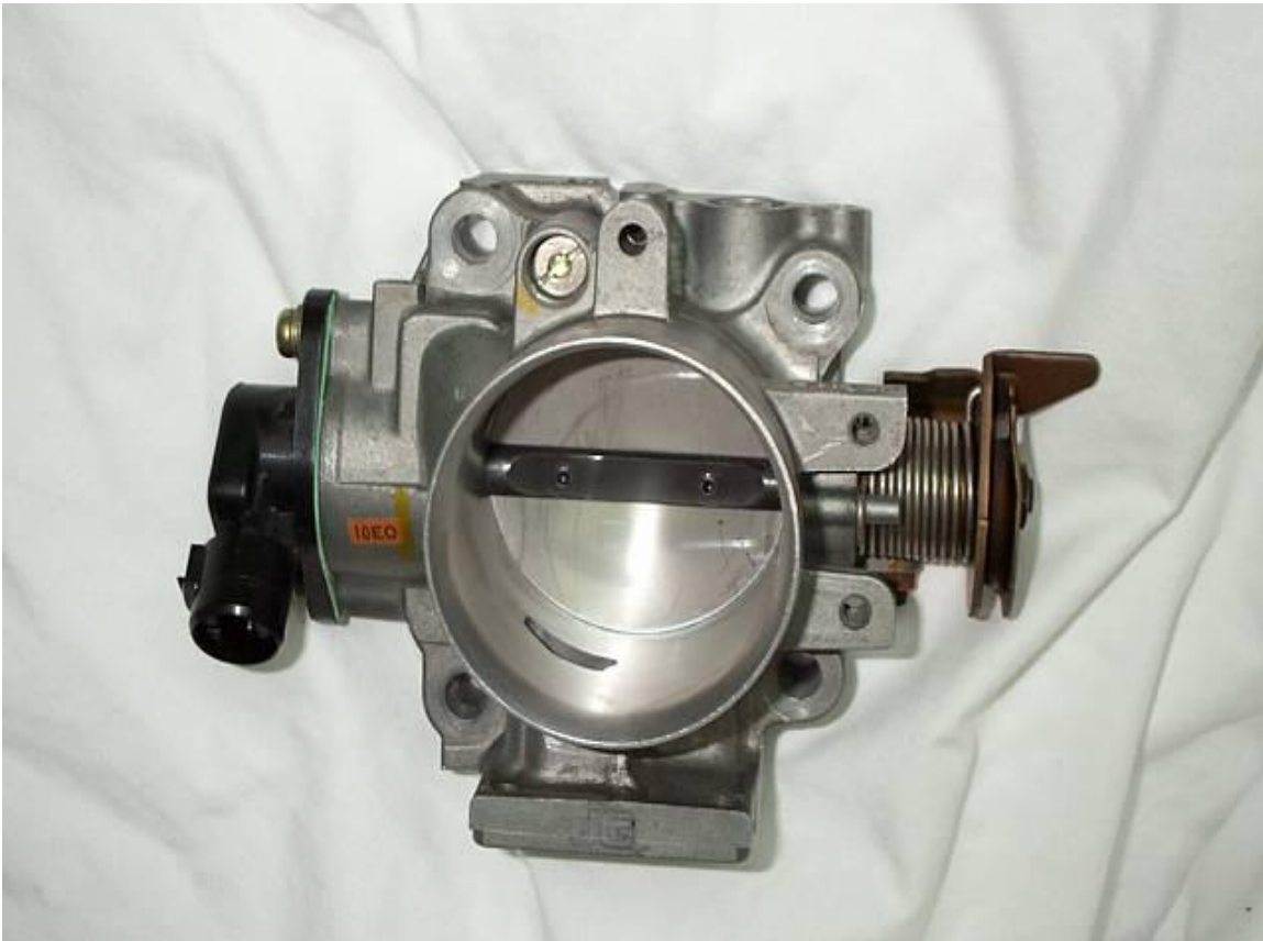
Σχήμα 1.13: Στα αριστερά αυτού του “μπλοκ” “πεταλούδας”, μηχανικής σύνδεσης με το “πεντάλ”, παρατηρείται ο αισθητήρας γωνίας “πεταλούδας” [17].
