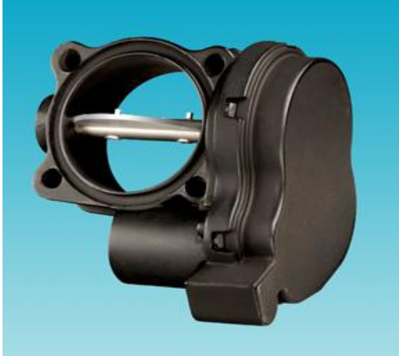
Σχήμα 1.8: Σύνθετη ρυθμιστική δικλείδα ηλεκτρονικού ελέγχου της Delphi με αισθητήρα μη – επαφής και ηλεκτροκινητήρα συνεχούς τάσεως (DC) [13].
