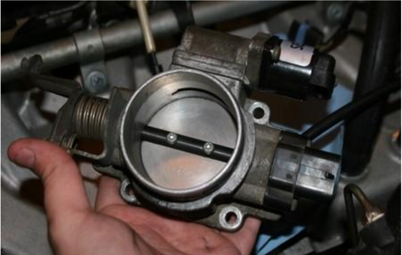
Σχήμα 1.15: Στο επάνω μέρος και στα δεξιά διακρίνεται η βαλβίδα ελέγχου της ελάχιστης παροχής του αέρα (Idle Air Control Valve). Επίσης διακρίνεται και η θυρίδα οδήγησης του αέρα από τον κύριο αγωγό της πεταλούδας σε αυτήν [19].
