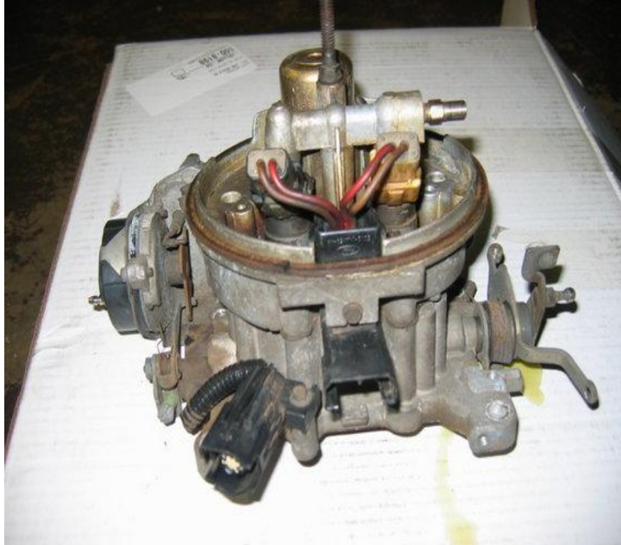
Σχήμα 1.20: Η αντίστοιχη τεχνολογία από την Ford γνωστή ως CFI. Διακρίνονται οι δύο εγχυτήρες προσαρτημένοι επί του μπλοκ του εξαεριοτή [24].
