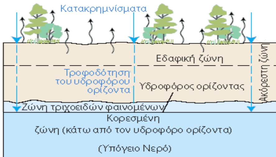
Εικόνα 2: Κίνηση νερού υπογείως - Τομή εδάφους (U.S. Geological Survey μετάφραση ΕΜΠ)
