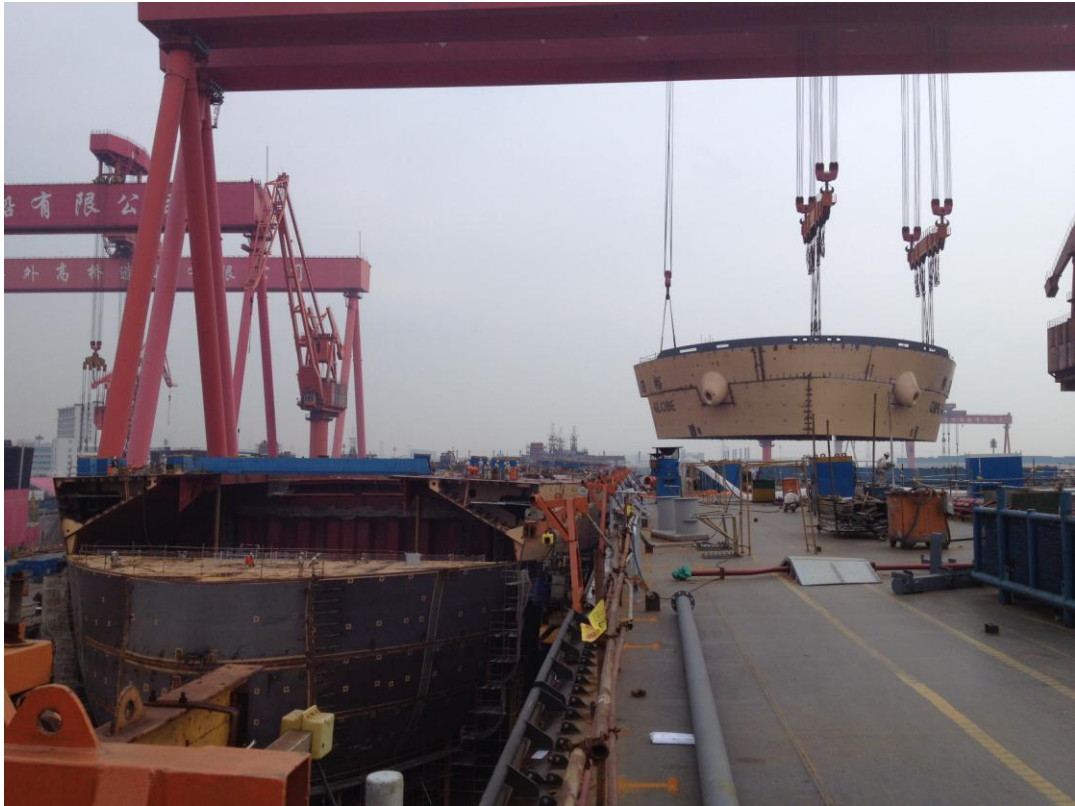
Μεταφορά τομέα προς συγκόλληση στην δεξαμενή (Κίνα)
