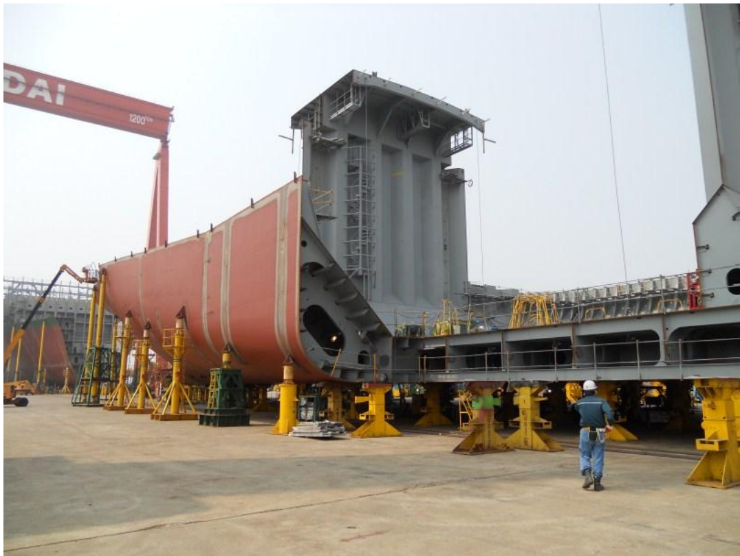
Κατασκευή τομέων Κορέα
