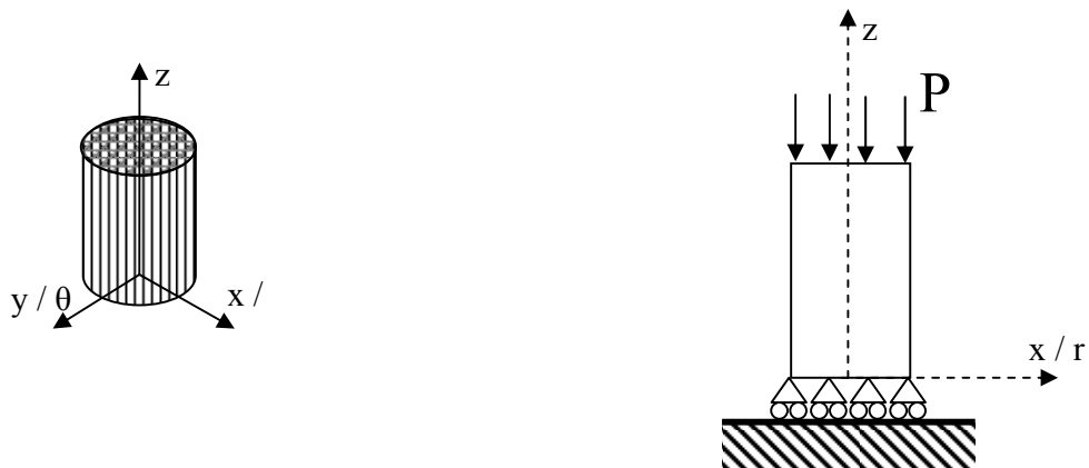
Σχήμα 3.1.1: Τρισδιάστατη παράσταση του κυλινδρικού μοντέλου. Οριακές συνθήκες και φόρτιση για την περίπτωση 3.1
