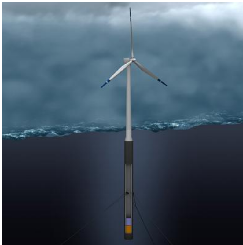
Εικόνα 2.19: Πλωτή κατασκευή τύπου Spar-Buoy
