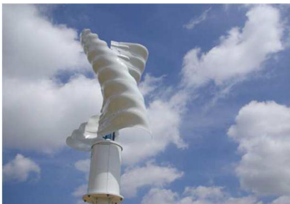
Εικόνα 2.3: Ανεμογεννήτρια κατακόρυφου άξονα τύπου Savonius
