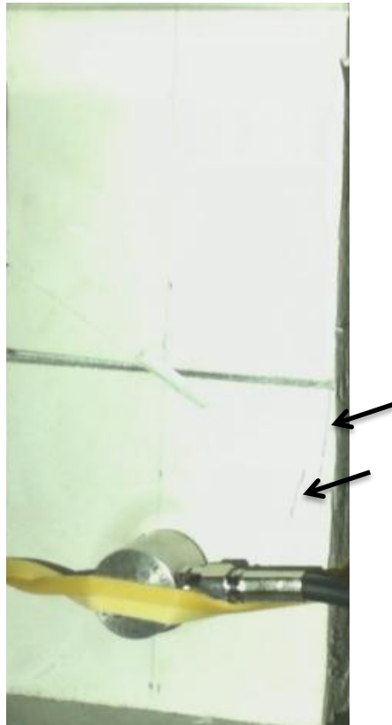
Φωτογραφία 6.18: Δημιουργία ρωγμών κάθετων στην ασυνέχεια.
