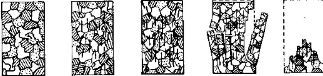
Σχήμα 1.9: Αστοχία Γρανίτη από λυγισμό και αποφλοιώση.
