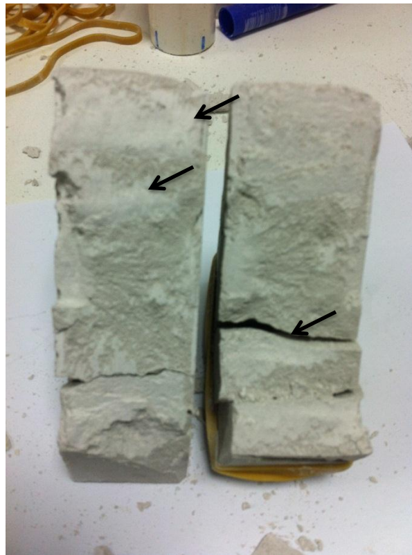
Φωτογραφία 6.74:Σημάδια Ολίσθησης και εφελκυστικές ρωγμές.
