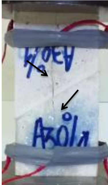
Φωτογραφία 5.10:Ρωγμές σχεδόν κάθετες με γωνία 60^\circ από την ασυνέχεια.
