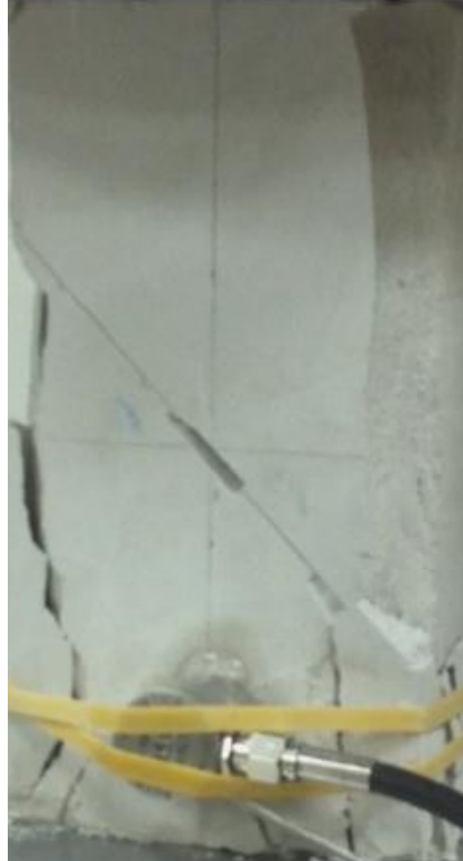
Φωτογραφία 6.64:Θραύση δοκιμίου χωρίς να παρατηρείται ολίσθηση στο επίπεδο ασυνέχειας.
