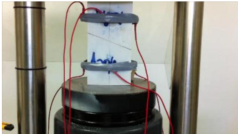
Φωτογραφία 5.5: Δοκίμο την στιγμή της φόρτισης πριν την εμφάνιση ρωγμών.
