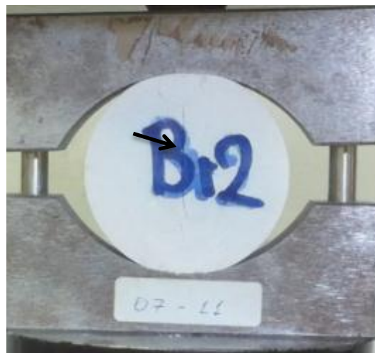
Φωτογραφία 4.10: Ομοίως έναρξη ρωγμής από το κέντρο του δοκιμίου Br2
