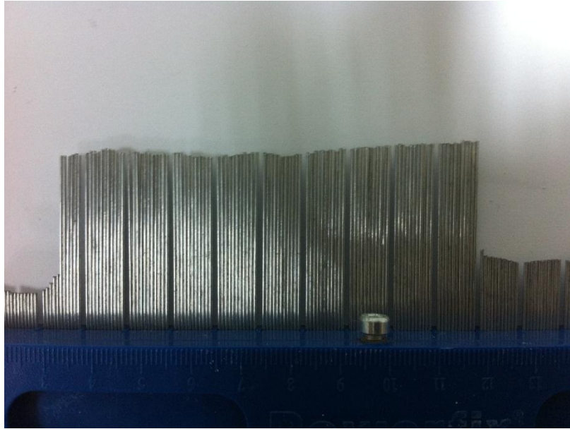
Φωτογραφία 6.37:Μέτρηση στο τρίτο τμήμα της ασυνέχειας.
