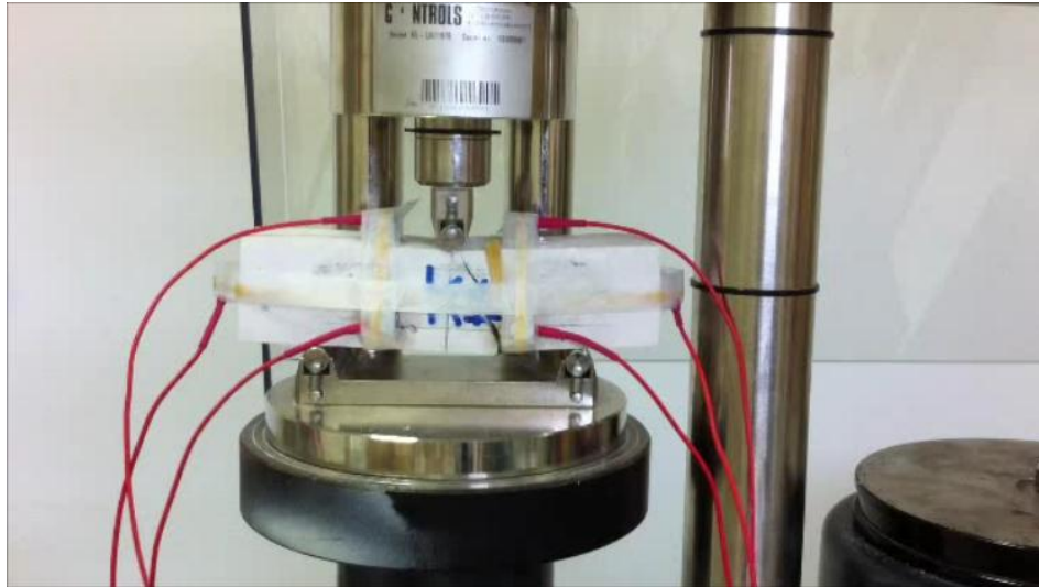
Φωτογραφία 4.15: Διάνοιξη ρωγμής και αστοχία του δοκιμίου.
