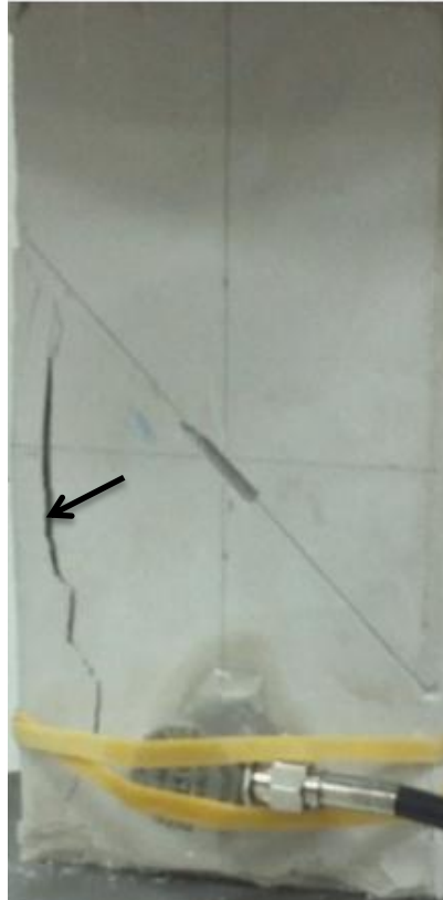
Φωτογραφία 6.62: Άνοιγμα ρωγμής και αποφλοίωση.
