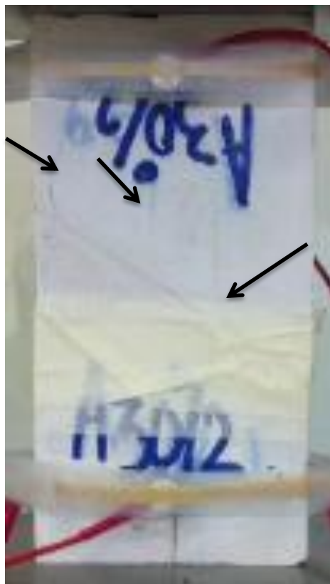
Φωτογραφία 5.11:Δοκίμιο με ρωγμές σχεδόν κάθετες.
