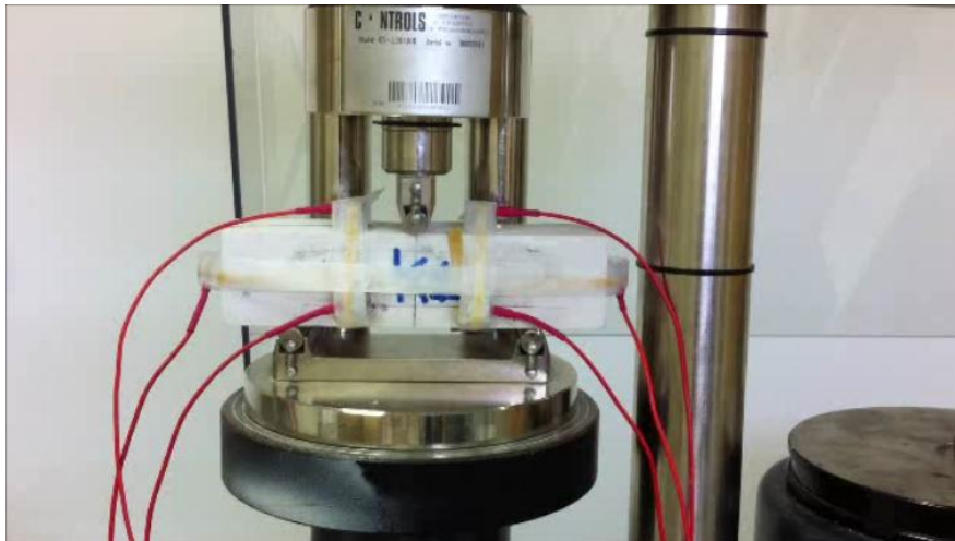
Φωτογραφία 4.14: Κατά την εκτέλεση της δοκιμής χωρίς να παρατηρηθεί κάποια ρωγμάτωση.
