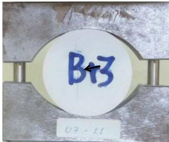
Φωτογραφία 4.12: Για το δοκίμιο Br3 έναρξη ρωγμής από το κέντρο του δοκιμίου.
