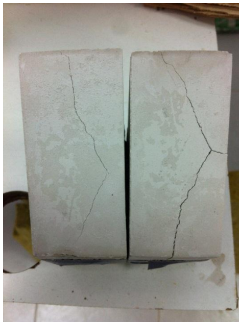
Φωτογραφία 5.13: A30_1 δοκίμιο. Εφελκυστικές ρωγμές ξεκινάνε από την ασυνέχεια.
