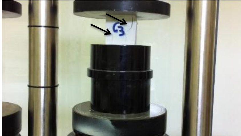
Φωτογραφία 4.18: Δημιουργία ρωγμών παράλληλων με την διεύθυνση φόρτισης.
