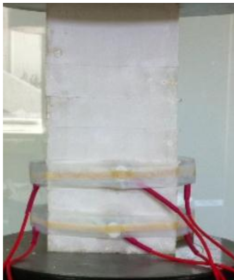
Φωτογραφία 5.25: Δοκίμιο As0_1 πριν το σχηματισμό ρωγμών.
