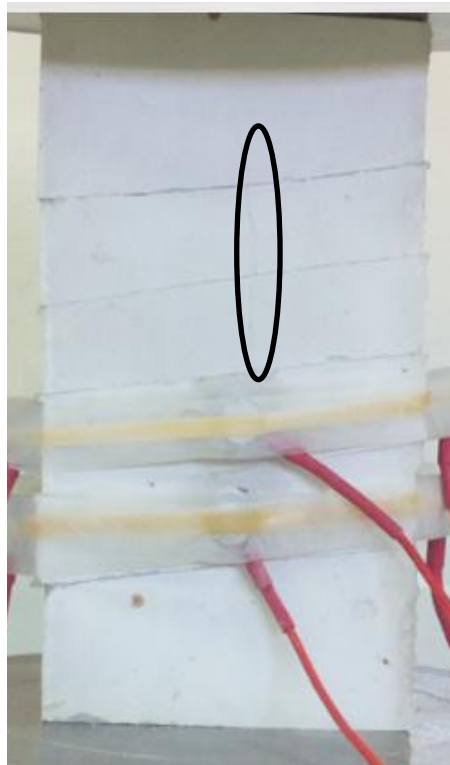
Φωτογραφία 5.31: Δημιουργία ρωγμής κατά μήκος επιπέδων ασυνεχειών.
