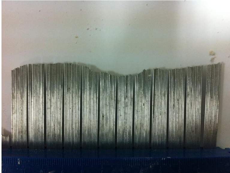
Φωτογραφία 6.66:Μέτρηση του προφιλ της ασυνέχειας στο μπροστά τμήμα.
