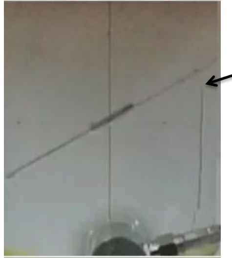
Φωτογραφία 6.30: Διάδοση έως τη τεχνητή ασυνέχεια.
