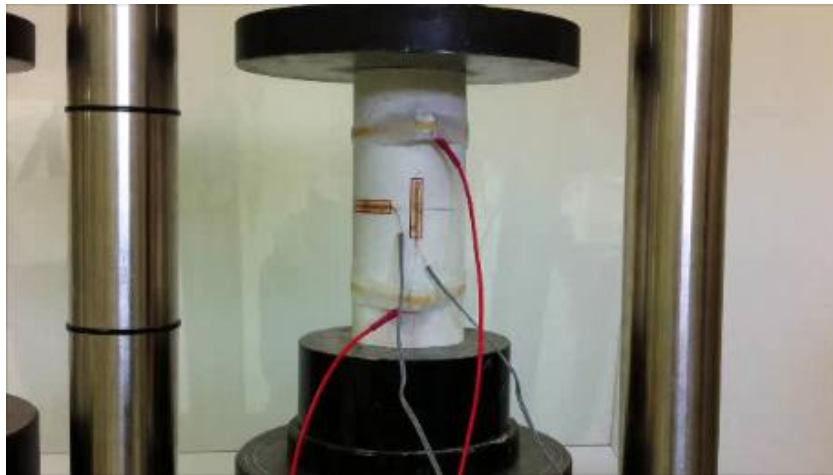
Φωτογραφία 4.20: Δοκίμιο Cy4 κατά την Φόρτιση με Strain Gauges.
