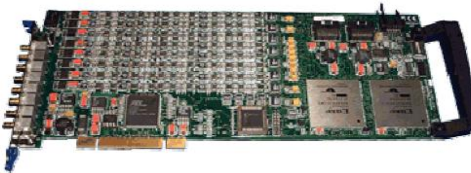
Φωτογραφία 3.1: Ψηφιακό σύστημα καταγραφής δεδομένων ΑΕ.
