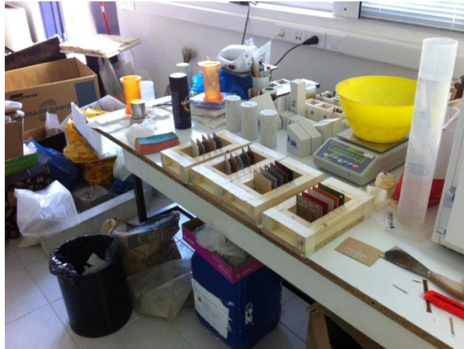
Φωτογραφία 5.23: Καλούπια για την κατασκευή πρισμάτων με 5 παράλληλα επίπεδα ασυνεχιών.
