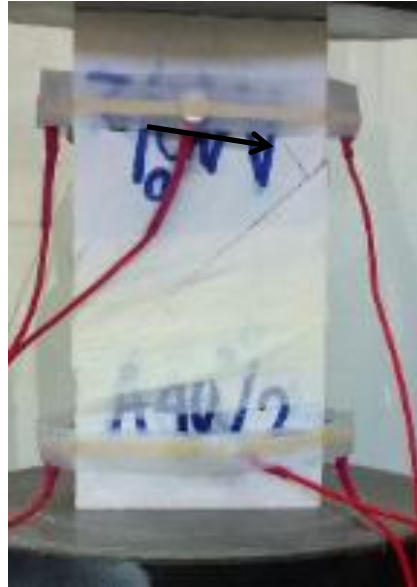
Φωτογραφία 5.17: Ρωγμή κάθετη στο επίπεδο της ασυνέχειας.
