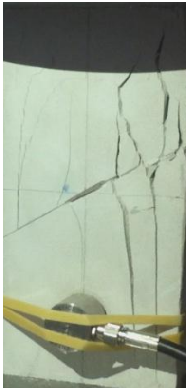
Φωτογραφία 6.10: Διεύρυνση των ρωγμών και θραύση δοκιμίου.
