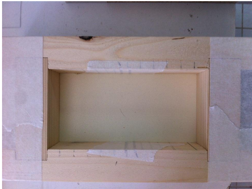
Φωτογραφία 4.1: Ξύλινο καλούπι για τη παρασκευή των δοκιμών.
