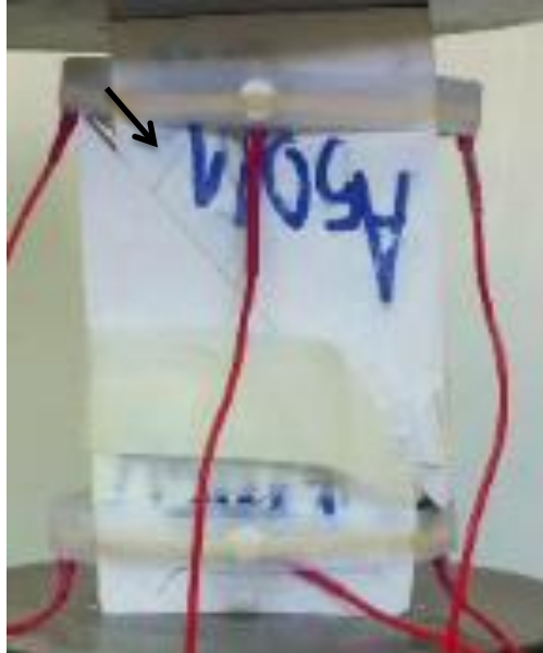
Φωτογραφία 5.22: Δημιουργία ρωγμής λίγο πριν τη θραύση.
