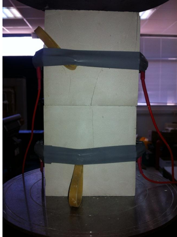
Φωτογραφία 5.4: Δοκίμιο με κλίση εμμένουσας ασυνέχειας 0° μετά την θραύση.
