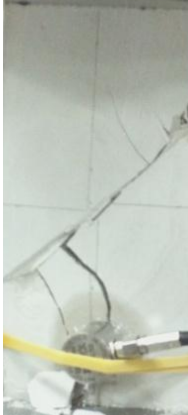
Φωτογραφία 6.56: Ολίσθηση και θραύση δοκιμίου.
