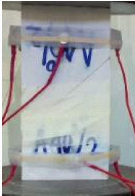
Φωτογραφία 5.16: Αρχικό στάδιο φόρτισης δεν παρατηρείτε ρωγμάτωση.
