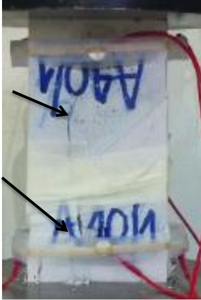
Φωτογραφία 5.15: Ρωγμές δοκιμίου κατά την φόρτιση.
