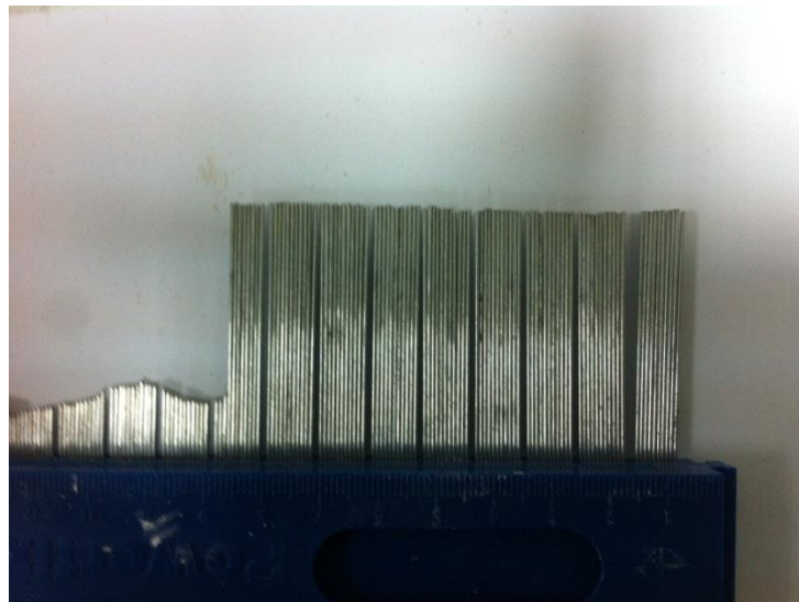
Φωτογραφία 6.23: Μέτρηση τραχύτητας με προφιλόμετρο στο μπροστινό τμήμα της ασυνέχειας.
