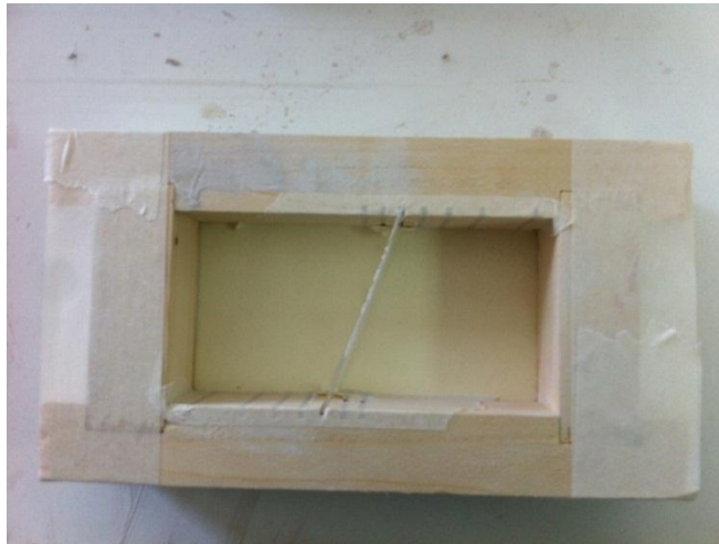
Φωτογραφία 5.1: Καλούπι για τη κατασκευή δοκιμίου με ασυνέχεια κλίσης 20^\circ .
