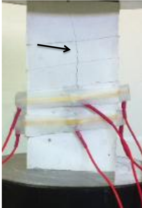
Φωτογραφία 5.32: Δημιουργία ρωγμής παράλληλη με διεύθυνση φόρτισης.
