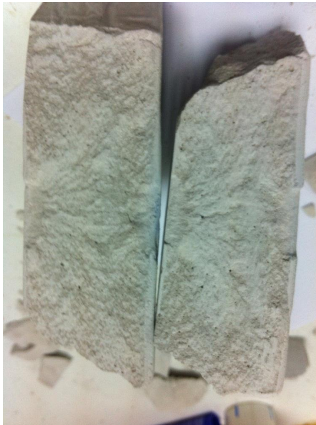
Φωτογραφία 6.34:Ίχνη διάτμησης στο τεχνητό επίπεδο ασυνέχειας.
