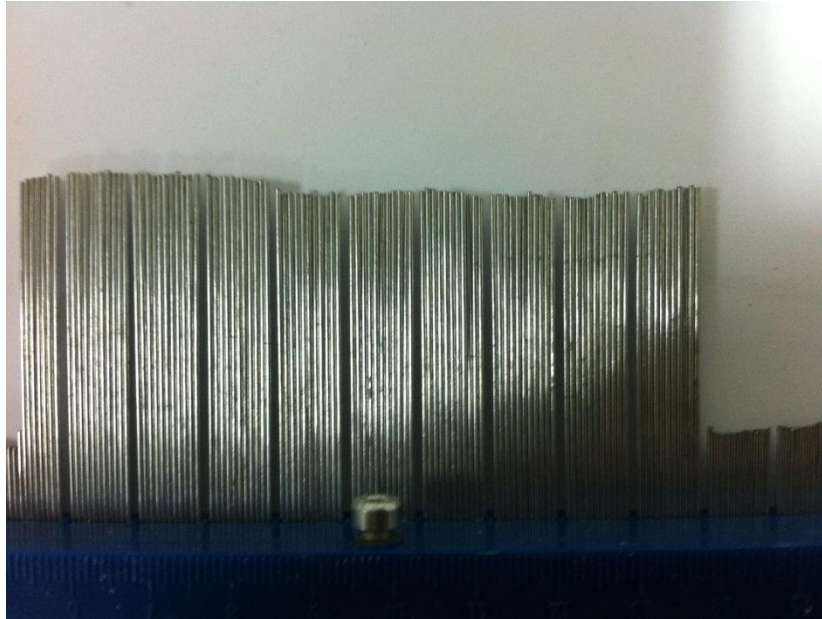
Φωτογραφία 6.35:Μέτρηση τραχύτητας στο μπροστά τμήμα της ασυνέχειας.
