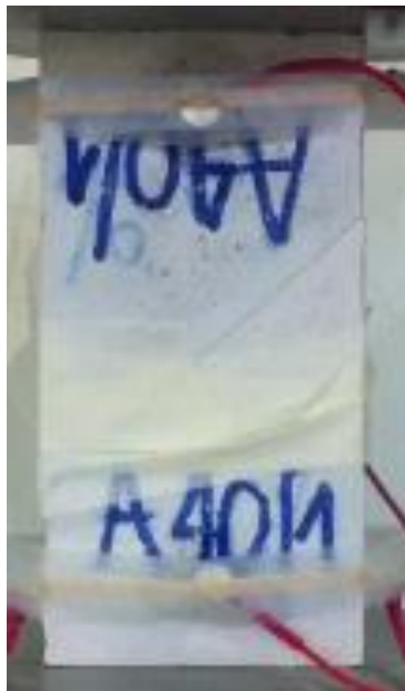
Φωτογραφία 5.14:Δοκίμιο κατά τη φόρτιση πριν τη ρωγμάτωση του.
