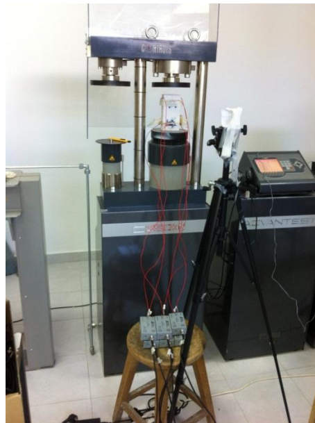
Φωτογραφία 5.2: Δοκίμιο με εγκαταστημένους αισθητήρες ΑΕ λίγο πριν την έναρξη δοκιμής.
