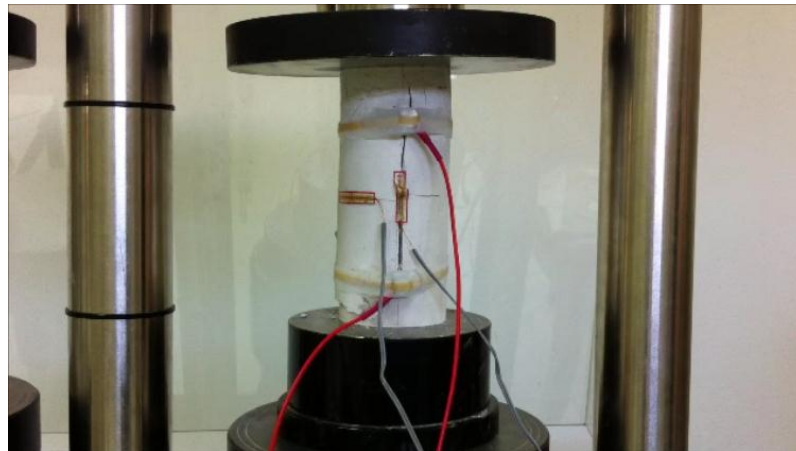
Φωτογραφία 4.22: Διεύρυνση της ρωγμής και αστοχία του δοκιμίου.
