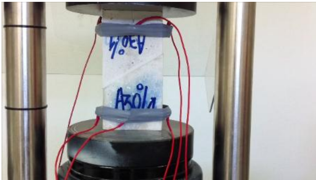
Φωτογραφία 5.9: Δοκίμιο κατά την φόρτιση πριν την εμφάνιση ρωγμών.
