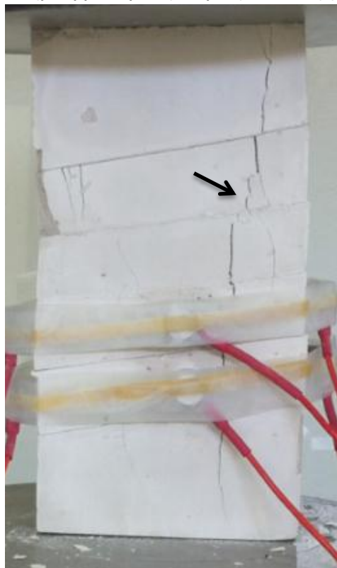
Φωτογραφία 5.29: Ένωση και άνοιγμα των αρχικών ρωγμών.
