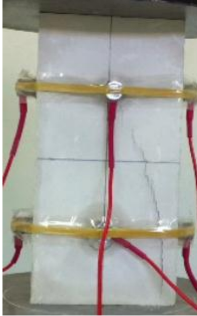
Φωτογραφία 4.28: Δημιουργία ρωγμή παράλληλης της διεύθυνσης φόρτισης
