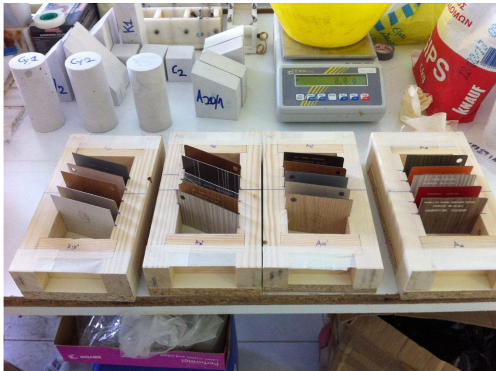
Φωτογραφία 5.24: Καλούπια Κατασκευής δοκιμών με 5 παράλληλες ασυνέχειες.
