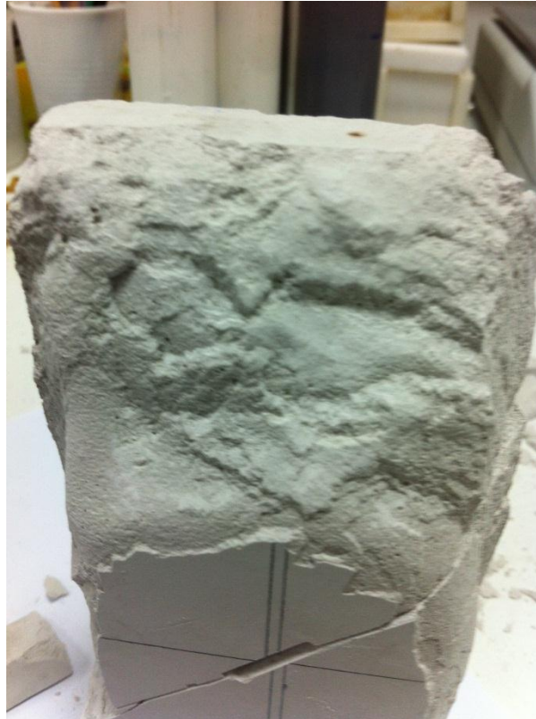
Φωτογραφία 6.49: Λοξό επίπεδο διάτμησης.
