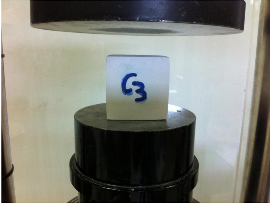
Φωτογραφία 4.16: Κυβικό δοκίμιο λίγο πριν την εκτέλεση της δοκιμής.
