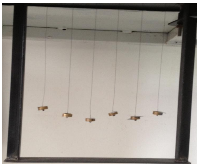
Εικόνα 5.2. Βάρη τανυσμού της ακρυλικής ίνας
