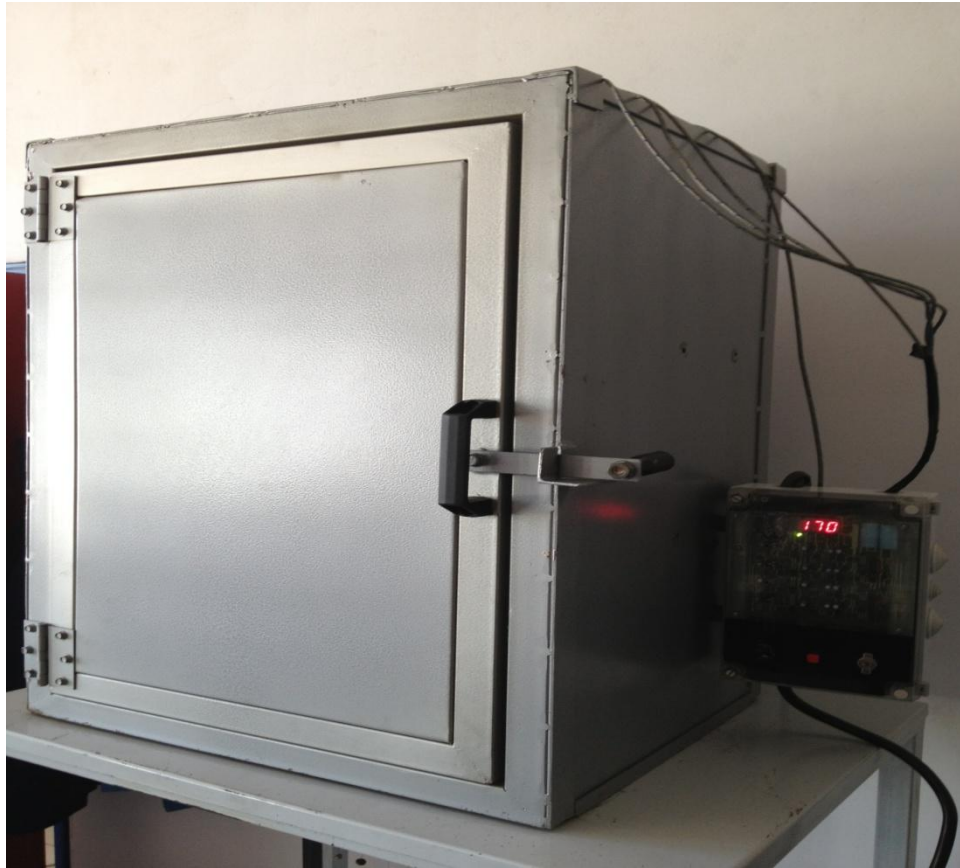
Εικόνα 5.1. Φούρνος οξειδωτικής σταθεροποίησης ινών πολυακρυλονιτριλίου διαλείποντος έργου
