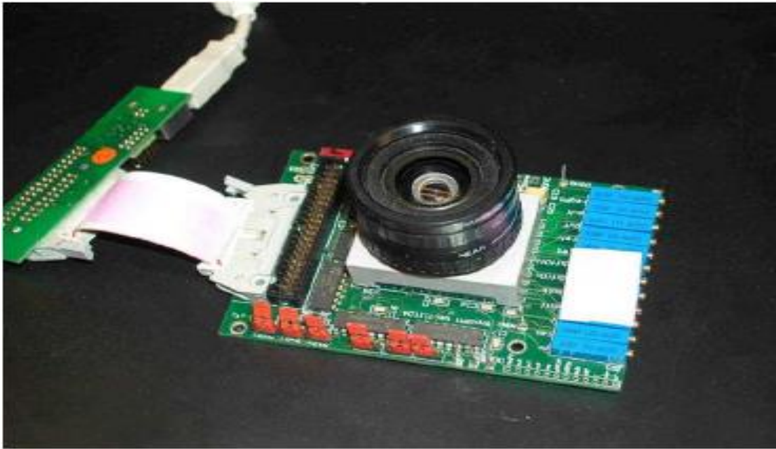
Εικόνα 3: Ασύγχρονος αισθητήρας όρασης χρονικής αντίθεσης( ATC) για την ανίχνευση πτώσεων [3].
