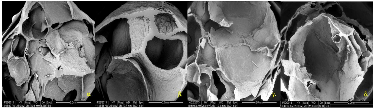
Εικόνα 24: Δομή προϊόντων εκβολής με πρόσθετο την ινουλίνη με X=17\% , T=160^{\circ}\text{C} , R=200\text{ rpm} και συγκέντρωση της ινουλίνης α) C=0\% , β) C=5\% , γ) C=10\% και δ) C=15\% .
