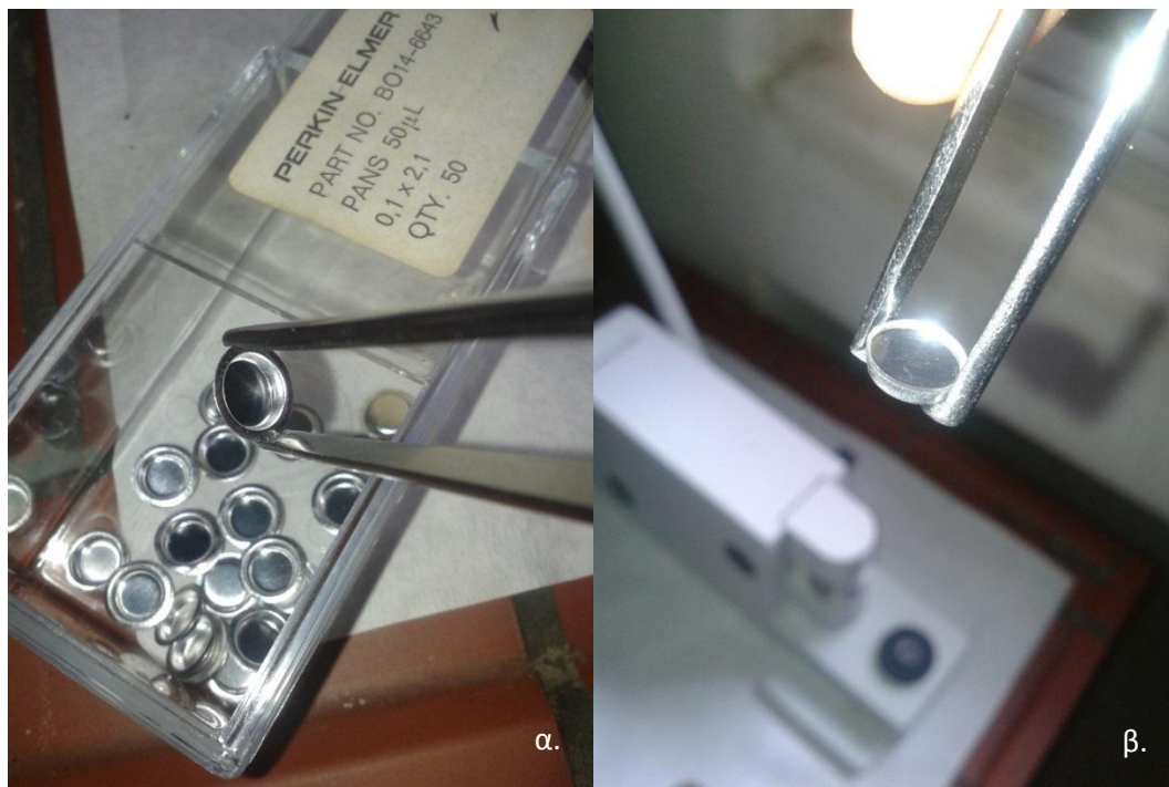
Εικόνα 24: Ειδικά καψύλλια αλουμινίου (50 µL, Perkin–Elmer). α) Καψύλλιο άδειο β) Καψύλλιο σφραγισμένο μετά από τη χρήση της πρέσας.
