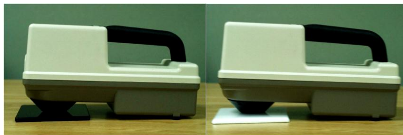
Εικόνα 18: Βαθμονόμηση φωτόμετρου MiniScan XE (Hunter Associates Laboratory Inc, Reston, Virginia).
