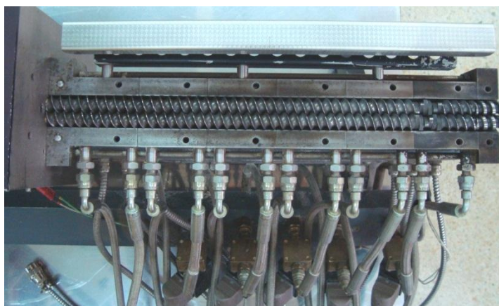
Εικόνα 5: Κάτοψη χιτωνίου εκβολέα διπλού κοχλία.
