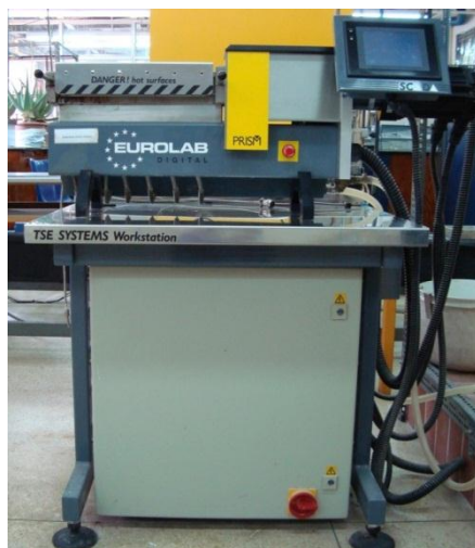
Εικόνα 4: Δεξιά πλάγια όψη εκβολέα. Διακρίνεται το χιτωνίο, ο κινητήρας και η οθόνη τύπου touch screen.
