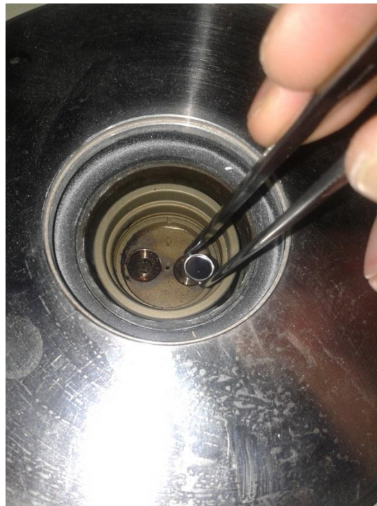
Εικόνα 25: Καψύλλιο αλουμινίου σφραγισμένο τοποθετείται στη Συσκευή διαφορικής θερμιδομετρίας σάρωσης Perkin Elmer DSC 6 (USA).
