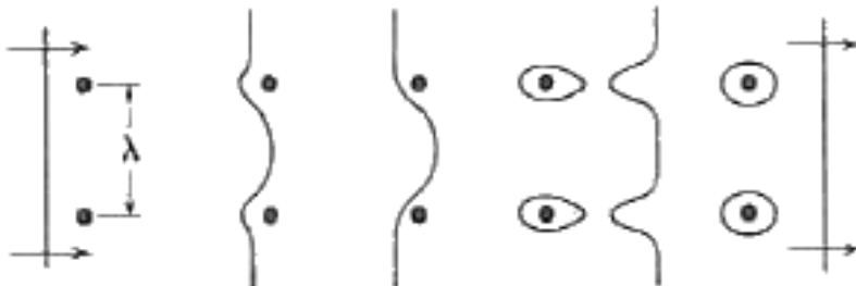
Σχήμα 2.16: Επίδραση της παρουσίας σωματιδίων ενίσχυσης στην κίνηση μιας διαταραχής.
