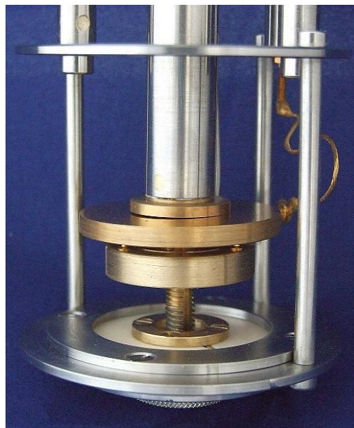
Σχήμα 5.9: Λεπτομέρεια κυψελίδας TSDC
