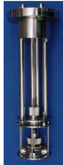
Σχήμα 5.6: Φωτογραφία κυψελίδας BDS 1200 της Novocontrol της διάταξης του DRS
