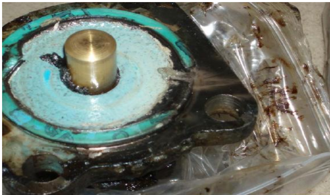
Εικόνα 8.2 : Η βαλβίδα απομόνωσης του καυσίμου
