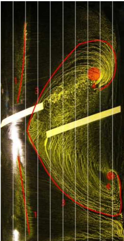
Εικόνα 3.ii.1 - Flow-viz FFA ΕΛ.Μ. 14^\circ , οι κατακόρυφες γραμμές αντιστοιχούν στις ανά 10% ποσοστιαίες θέσεις της χορδής
