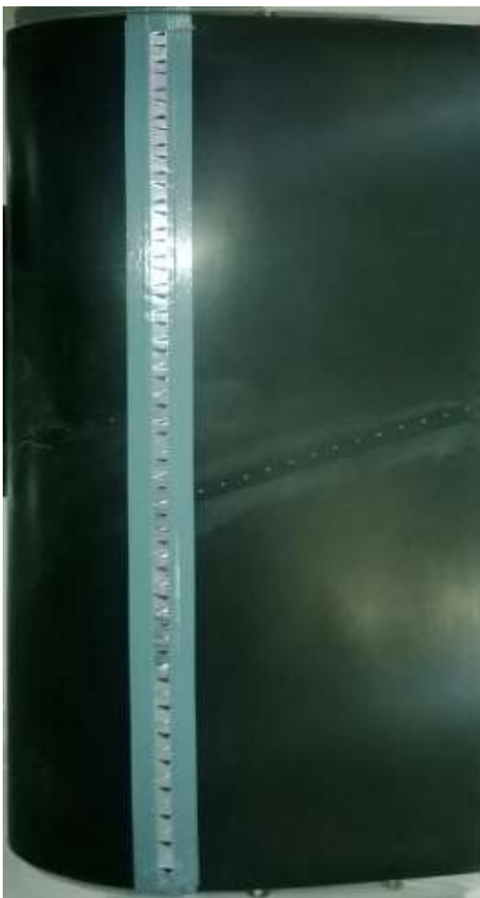
Εικόνα 2.i.4 -Η πτέρυγα FFA W3-241 με εγκατεστημένες τις στροβιλογεννήτριες h/d=1 (αριστερά) και h/d=1.6 (δεξιά)
