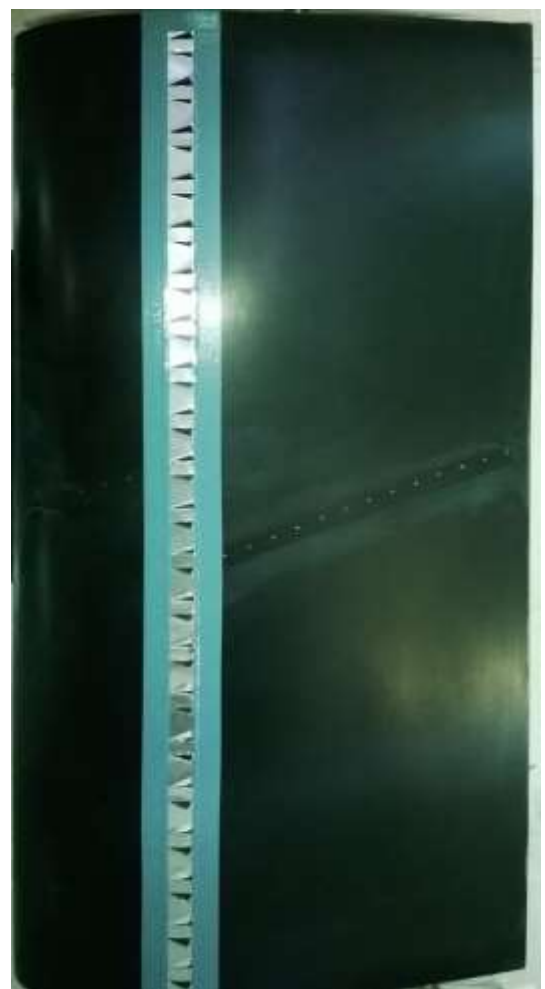
Εικόνα 2.i.4 -Η πτέρυγα FFA W3-241 με εγκατεστημένες τις στροβιλογεννήτριες h/d=1 (αριστερά) και h/d=1.6 (δεξιά)
