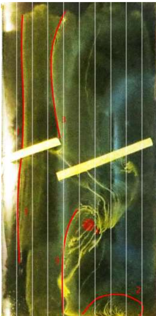
Εικόνα 3.ι.14- Flow-viz NACA Α.Λ.Α 14^\circ , οι κατακόρυφες γραμμές αντιστοιχούν στις ανά 10% ποσοστιαίες θέσεις της χορδής
