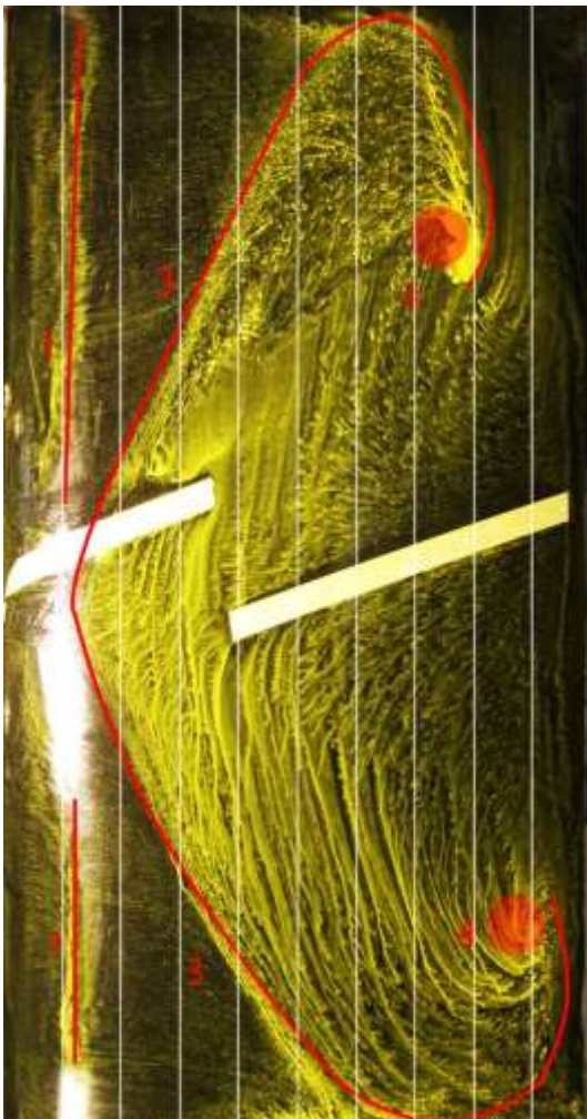
Εικόνα 3.ii.3 - Flow-viz FFA ΕΛ.Μ. 20^\circ , οι κατακόρυφες γραμμές αντιστοιχούν στις ανά 10% ποσοστιαίες θέσεις της χορδής
