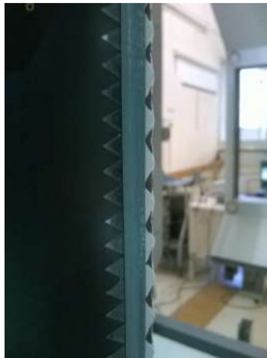
Εικόνα 2.ι.3 -Οδοντωτή λωρίδα αποκόλλησης τοποθετημένη στην πτέρυγα
