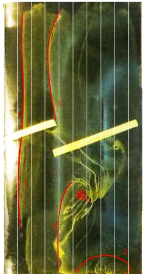
Εικόνα 3.i.7- Flow-viz NACA Α.Λ.Α. 14^\circ , οι κατακόρυφες γραμμές αντιστοιχούν στις ανά 10% ποσοστιαίες θέσεις της χορδής
