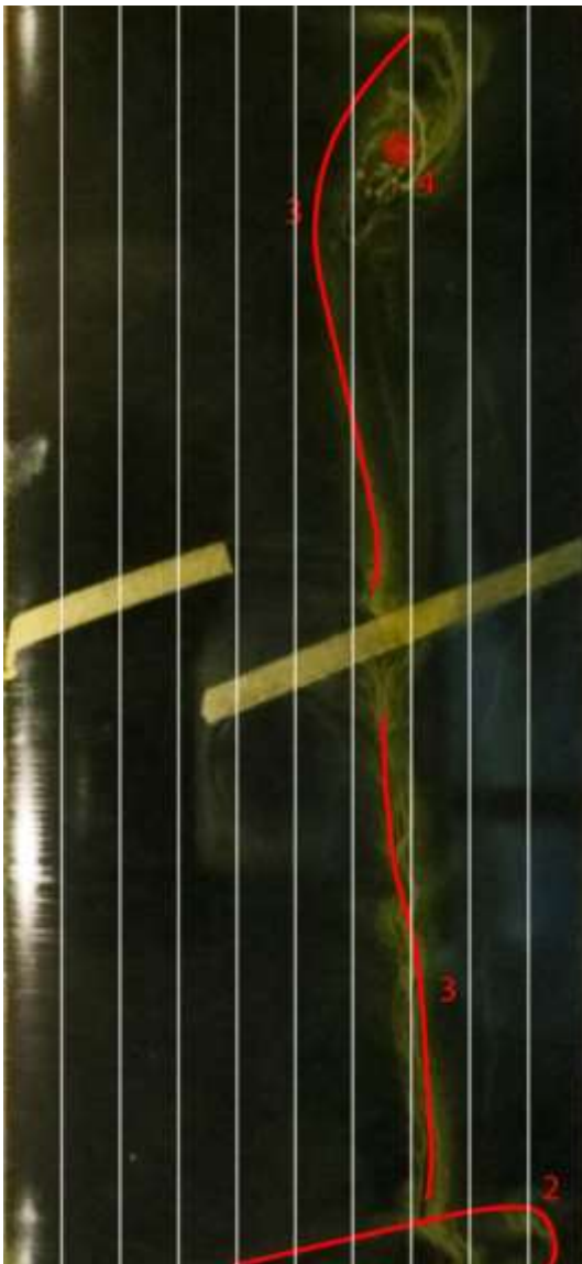
Εικόνα 3.ι.4- Flow-viz NACA Εξ.Μ. 11^\circ , οι κατακόρυφες γραμμές αντιστοιχούν στις ανά 10% ποσοστιαίες θέσεις της χορδής
