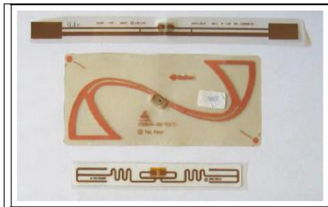
Σχήμα 4.1.1.α απεικονίζει τρεις διαφορετικές ετικέτες RFID, που χρησιμοποιούνται για την εκτέλεση των πειραμάτων που περιγράφονται. Το κεντρικό έχει διαστάσεις 11 x 5 cm.
