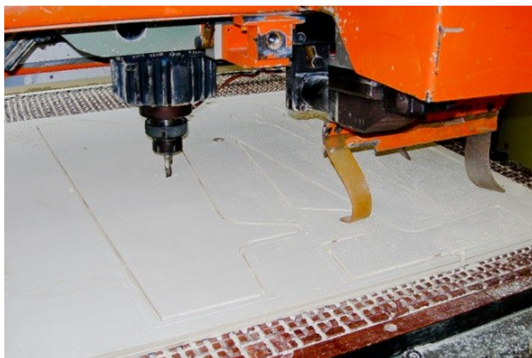
Κατασκευή καλουπιού για αντικολλητό με εργαλειομηχανή CNC.
