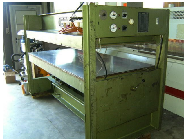
Πρέσες διάφορων χρήσεων με φύλλα αλουμινίου στις πλάκες.
