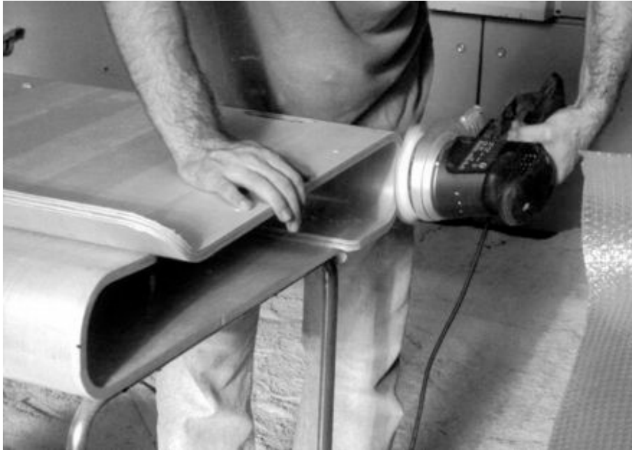
Λείανση επιφάνειας τραπεζιού από καμπύλο κόντρα πλακέ.
