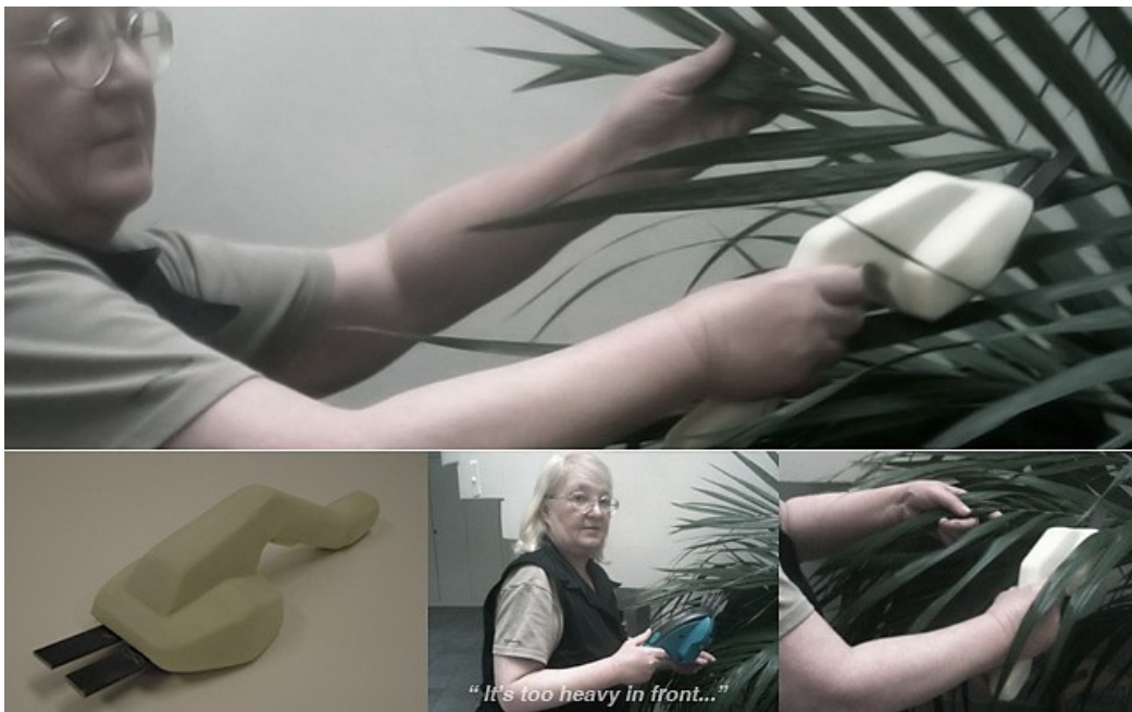
Λειτουργικό μοντέλο για το ψαλίδι κλαδέματος ώστε να ελεγχθεί η εργονομία αλλά και τυχόν δυσκολίες κατά τη χρήση.
