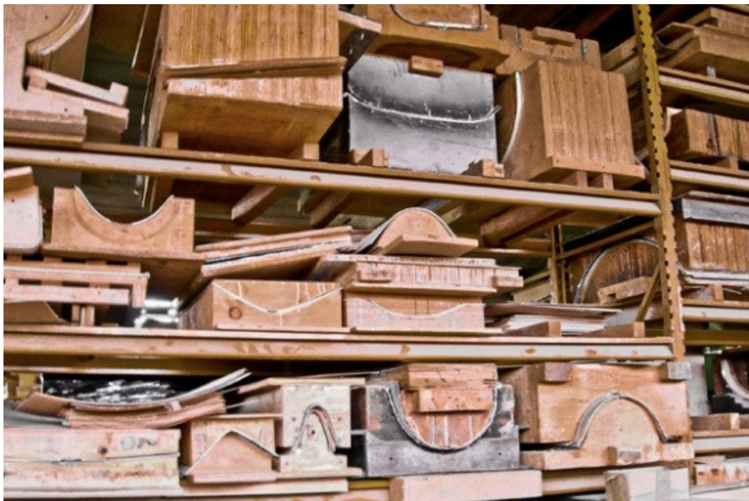
Κατασκευή καλουπιών και Σχ. Καλούπια για παραγωγή αντικολλητών καμπύλης μορφής.
