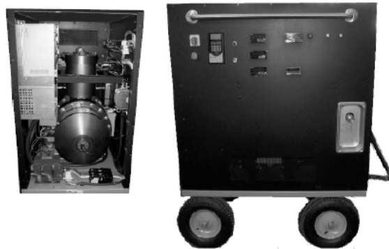
Σχήμα 4-28. 2d362K – 3FAR φορητό σύστημα παραγωγής υγροποιημένου οξυγόνου.
