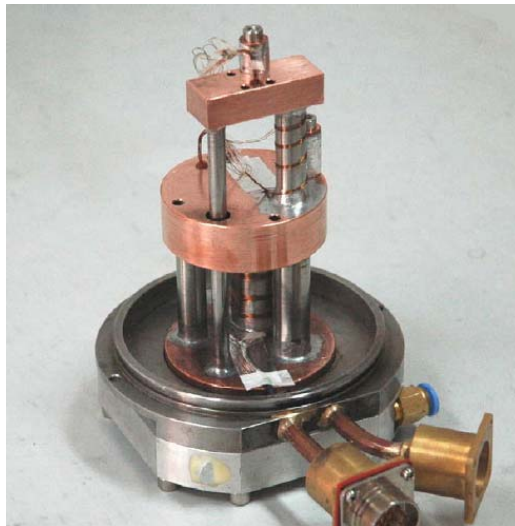
Σχήμα 6-4. Φωτογραφία με τα ψυχρά μέρη της ψυχρής κεφαλής.
