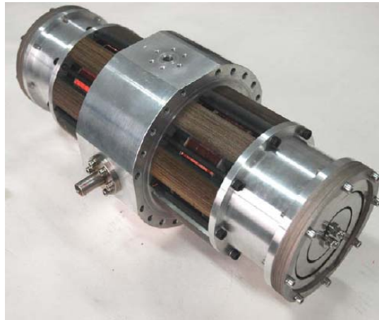
Σχήμα 6-3. Φωτογραφία της εσωτερικής δομής του συμπιεστή.
