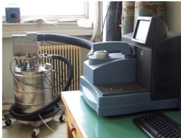
Σχήμα 3.6. Πειραματική διάταξη DSC.
