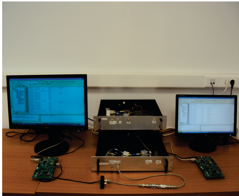
Σχήμα 2.6: Φωτογραφία του εξοπλισμού του εργαστηρίου για το υλοποιηθέν σύστημα. Απεικονίζονται τόσο οι πλακέτες DSK όσο και τα υποσυστήματα RF πομπού και δέκτη.
