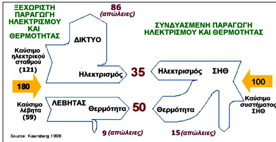
Εικόνα 17: Συμβατικό ενεργειακό σύστημα σε σύγκριση με σύστημα συμπαραγωγής (πηγή: www.cres.gr )
