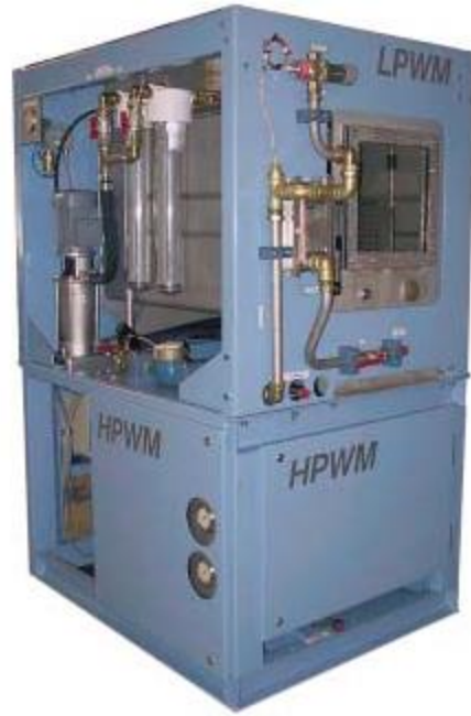
Εικόνα 3-6 Σύστημα ηλεκτρονικού ελέγχου απευθείας έγχυσης νερού.
