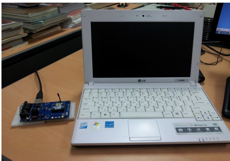
Εικόνα 54 : XBee connected to PC via Xbee interface board
