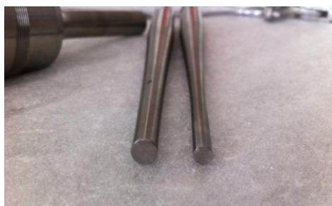
Εικόνα 2.5: Ηχόδια τιτανίου που χρησιμοποιήθηκαν στα πειράματα ηχοβόλησης (διαστάσεων 1/4'' και 3/16'' αντίστοιχα)
