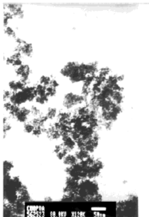
Εικόνα 1.12: Εικόνα TEM του σύνθετου υλικού CuO-PVA [37]
