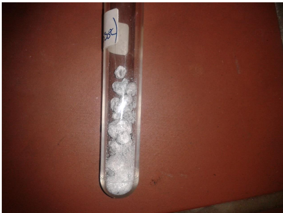
Εικόνα 4: τα σφαιρίδια ζεόλιθου μετά την καύση της μήτρας στο φούρνο αρχικά στους 550 και μετά στους 700°C
