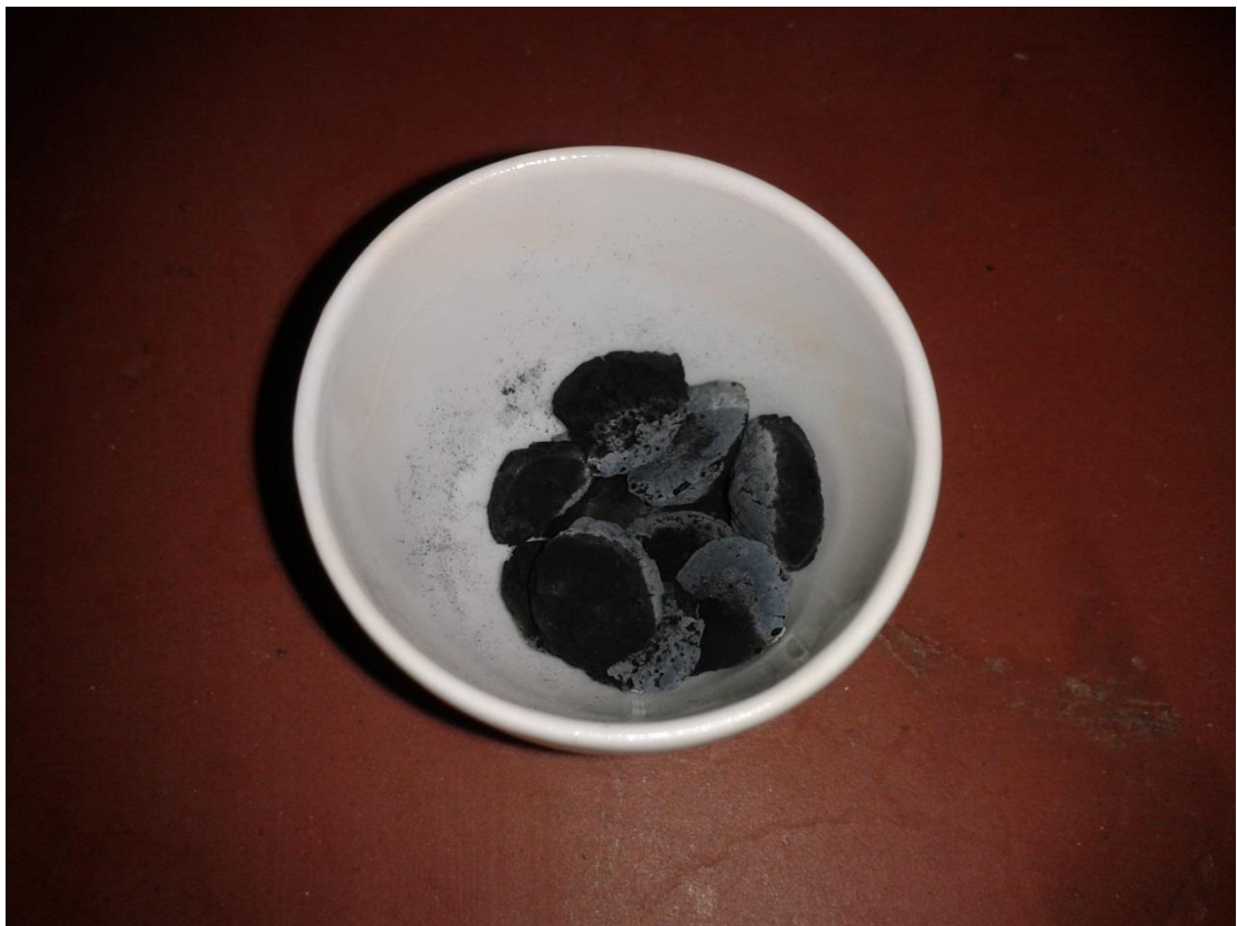
Εικόνα 3: τα pellets μετά την ενεργοποίηση τους στους 700°C στον κυλινδρικό φούρνο
