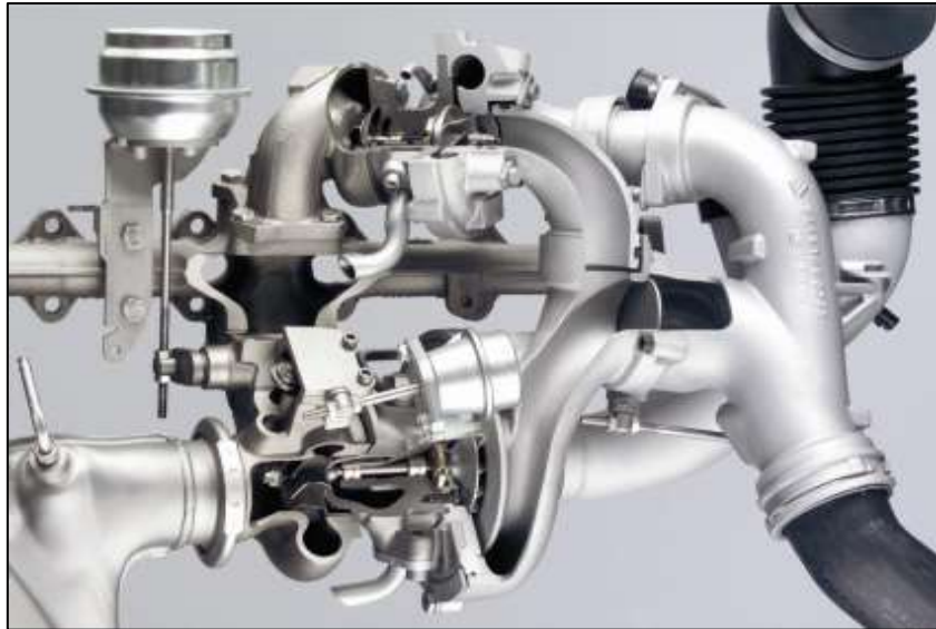
Σχήμα 2.2: Διβάθμια στροβιλο-υπερπλήρωση σε κινητήρα οχήματος όπου γίνεται αντιληπτό ο χώρος που απαιτείται για μια τέτοια εφαρμογή· το κάτω ζεύγος είναι της χαμηλής πίεσης και το πάνω ζεύγος της υψηλής πίεσης (φαίνεται επίσης και η διαφορά μεγέθους που υπάρχει μεταξύ τους)
