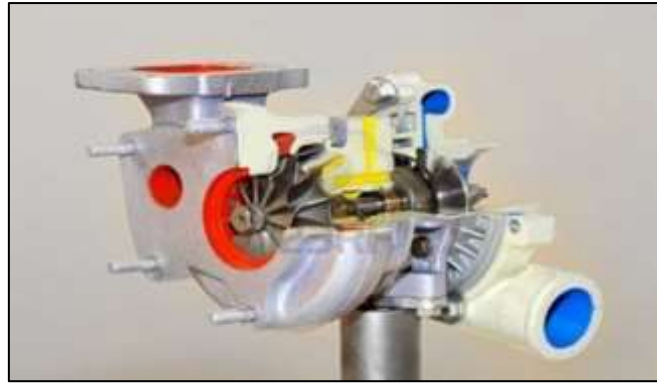
Σχήμα 1.6: Ζεύγος στροβιλο-υπερπληρωτή (γαλάζιο τμήμα: συμπιεστής, κόκκινο τμήμα: στρόβιλος, κίτρινο τμήμα: λίπανση της ατράκτου)
