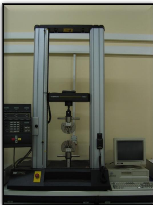
Εικόνα 3.5: Διάταξη δοκιμής σε εφελκυσμό
