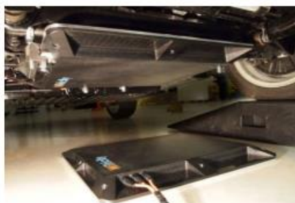
Εικόνα 1.15: Ασύρματη φόρτιση ηλεκτρικών αυτοκινήτων
