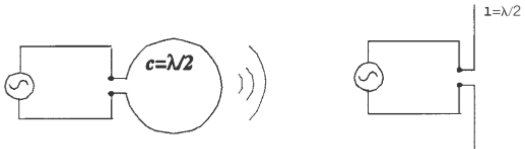
Εικόνα 1.2: Τα δύο βασικότερα είδη κεραίας του far field, βροχοειδής και διπολική[3]
