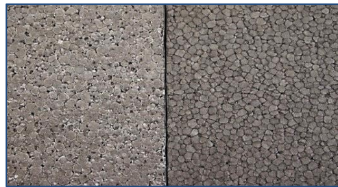
Εικόνα 2.11: Σύγκριση NEOPOR (αριστερά) και NEOPLAK (δεξιά)
