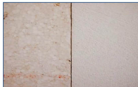
Εικόνα 2.6: Σύγκριση ISOPOR EPS 30 (αριστερά) και ISOPOR EPS 200 (δεξιά)
