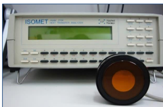
Εικόνα 5.15: ISOMET model 2104 και αισθητήρας επιφάνειας
