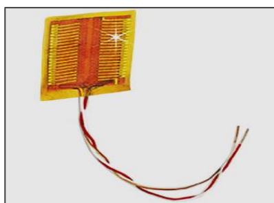
Εικόνα 5.20: Θερμοροόμετρο σειράς HFS
