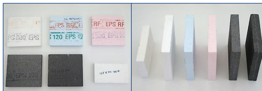
Εικόνα 2.13: Τα δείγματα EPS που εξετάστηκαν στην παρούσα εργασία
