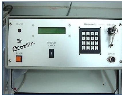
Εικόνα 5.12: Μονάδα ελέγχου CTmètre
