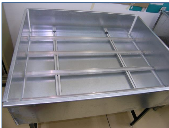
Εικόνα 4.3: Δεξαμενή μερικής εμβάπτισης
