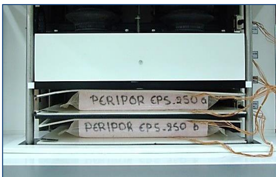
Εικόνα 5.5: Σωστή τοποθέτηση δειγμάτων
