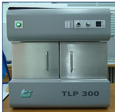
Εικόνα 5.1: Μετρητικός θάλαμος GHP- Πρόσοψη
