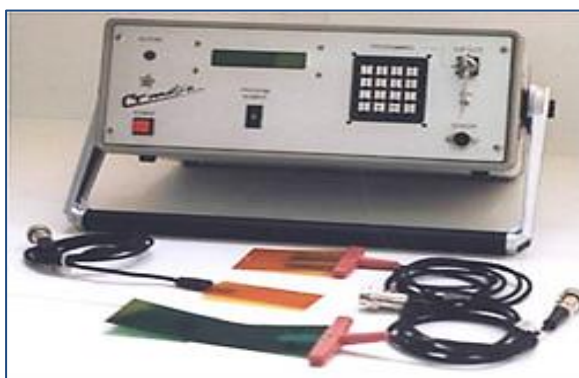
Εικόνα 5.11: Διάταξη CTmètre και αισθητήρες
