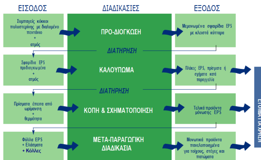
Εικόνα 2.3: Σχεδιάγραμμα παραγωγικής διαδικασίας διογκωμένης πολυστερίνης [41]
