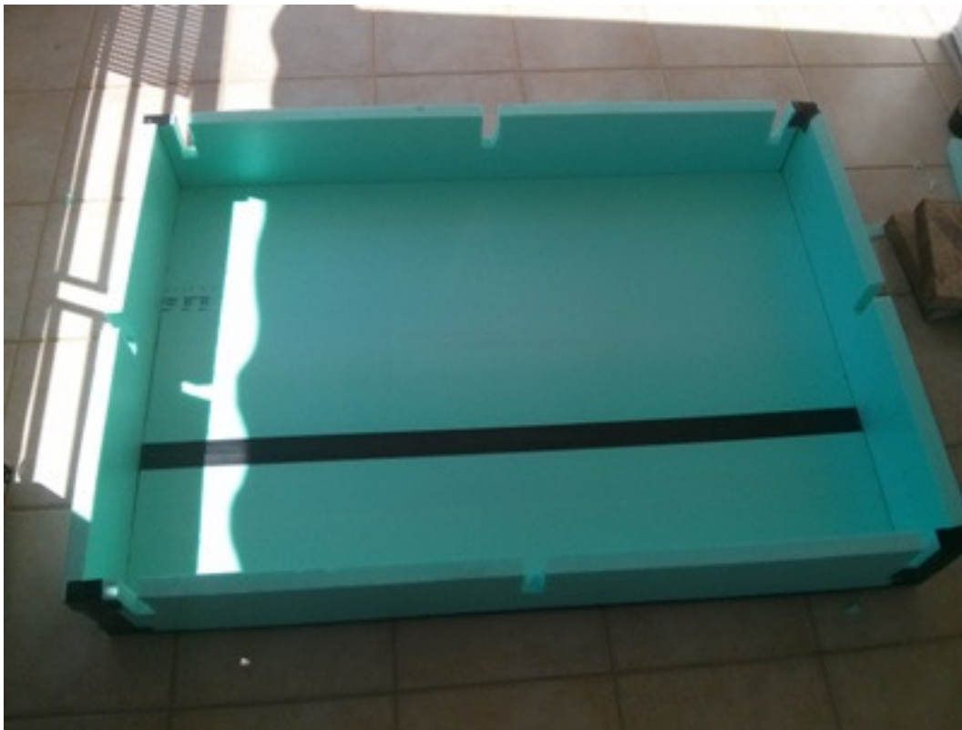
Εικόνα 7 : Μονωτικό περίβλημα εξηλασμένης πολυστερίνης.
