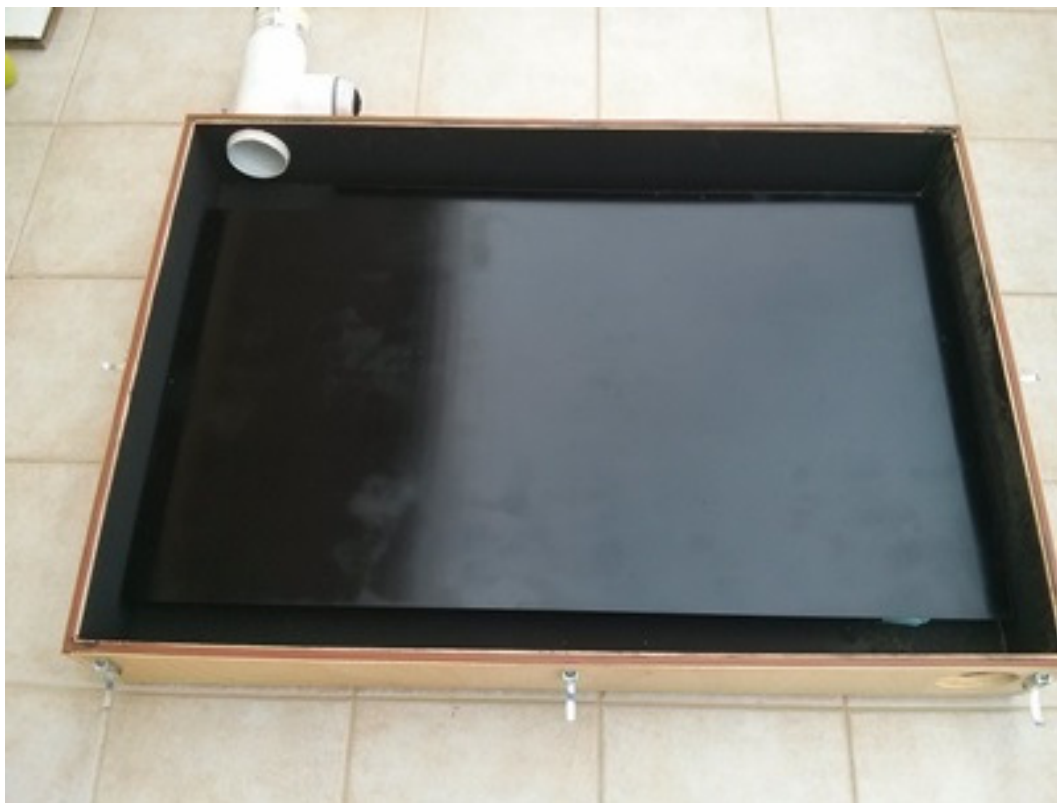
Εικόνα 6 : Δοκίμιο με μαύρη λαμαρίνα πάχους 1,25 χιλ.
