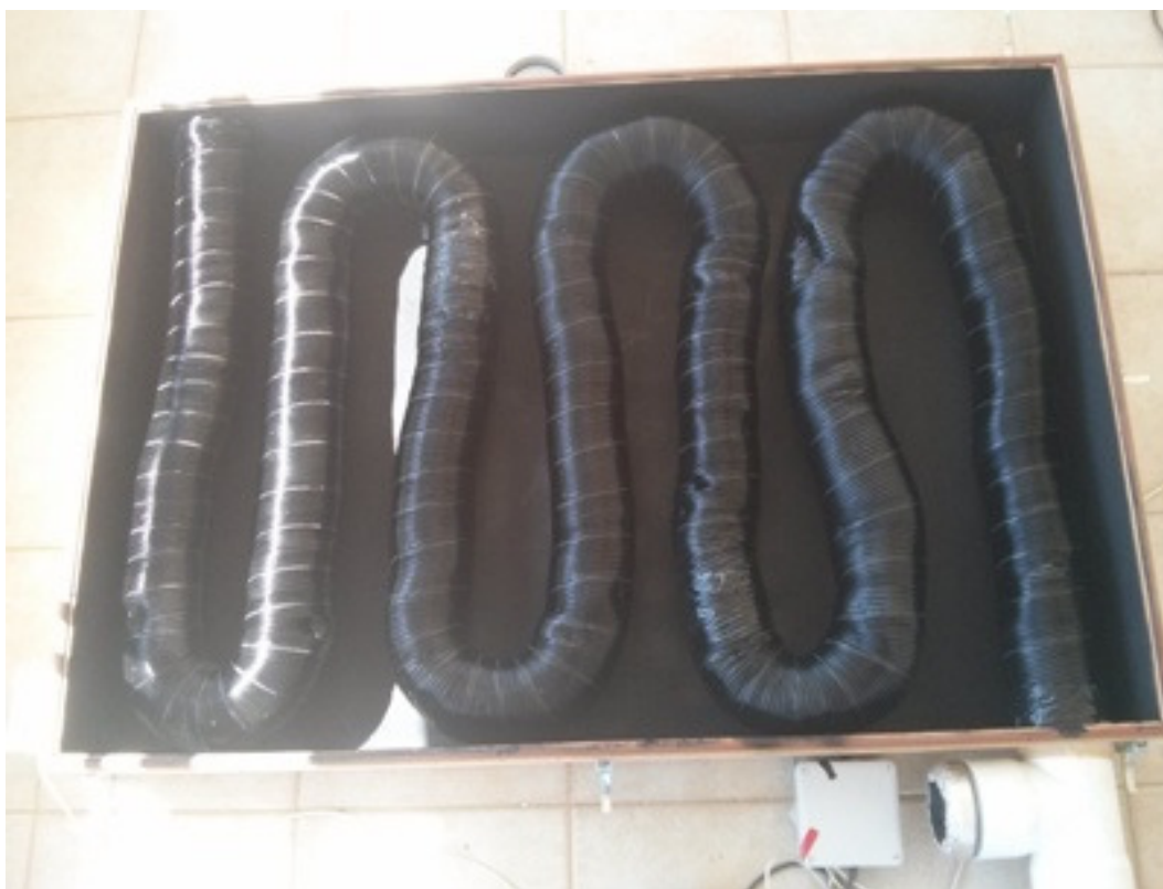
Εικόνα 4 : Διάταξη με μαύρο αεραγωγό αλουμινίου
