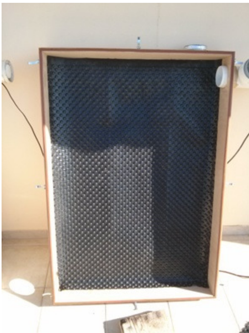
Εικόνα 3 : Διάταξη με μεμβράνη HDPE
