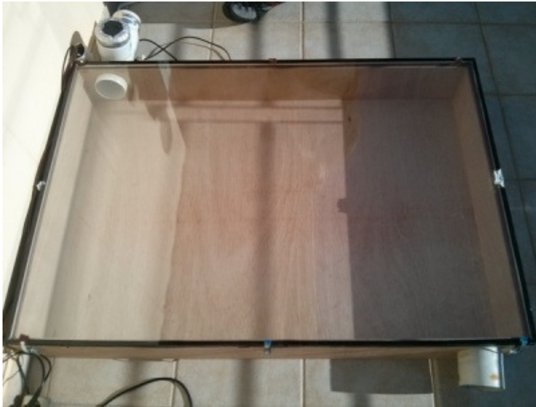
Εικόνα 1 : Ξύλινη κατασκευή με οπή εισόδου (κάτω δεξιά) και οπή εξόδου (επάνω αριστερά)
