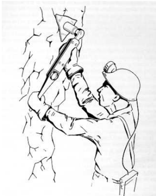
Σχήμα 39 Ένταση ήλου με μηχανικά διογκούμενο κωνικό περίβλημα με χρήση κλειδιού ελέγχου ροπής στρέψεως (Stillborg, 1994).
