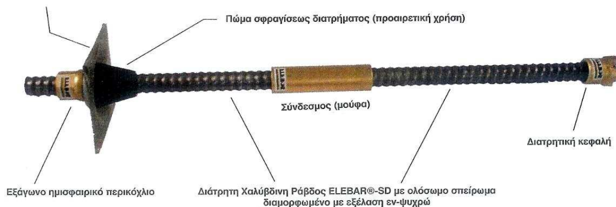
Σχήμα 35 Self-Drilling ήλος τύπου ELEBAR®-SD
