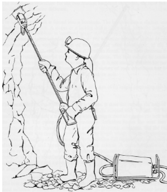
Σχήμα 42 Τοποθέτηση ήλου τύπου Swellex (Stillborg, 1994).
