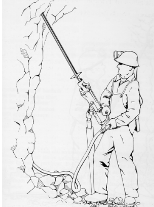
Σχήμα 41 Τοποθέτηση ενός ήλου τύπου Split Set (Stillborg, 1994).
