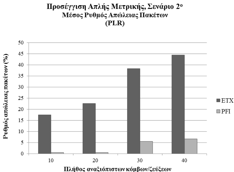
Σχήμα 17: Μέσος ρυθμός απώλειας πακέτων, όταν χρησιμοποιείται μόνο ETX ή PFI, θεωρώντας ότι δε συμβαίνουν αναμεταδόσεις λόγω άρνησης προώθησης πακέτων
