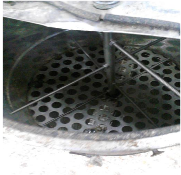
Εικόνα 30. Το σύστημα ανάδευσης με λεπτές ράβδους και η διάτρητη σχάρα
