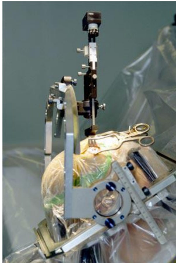
Εικόνα 12 Πραγματικό στερεοτακτικό πλαίσιο με προσαρμοσμένη τη διάταξη Ben Gun (με μαύρο χρώμα). Ξεχωρίζουν οι κοχλίες στερεοποίησης των μικροηλεκτροδίων, καθώς και ο κοχλίας που χρησιμεύει στη μετακίνηση της διάταξης.
