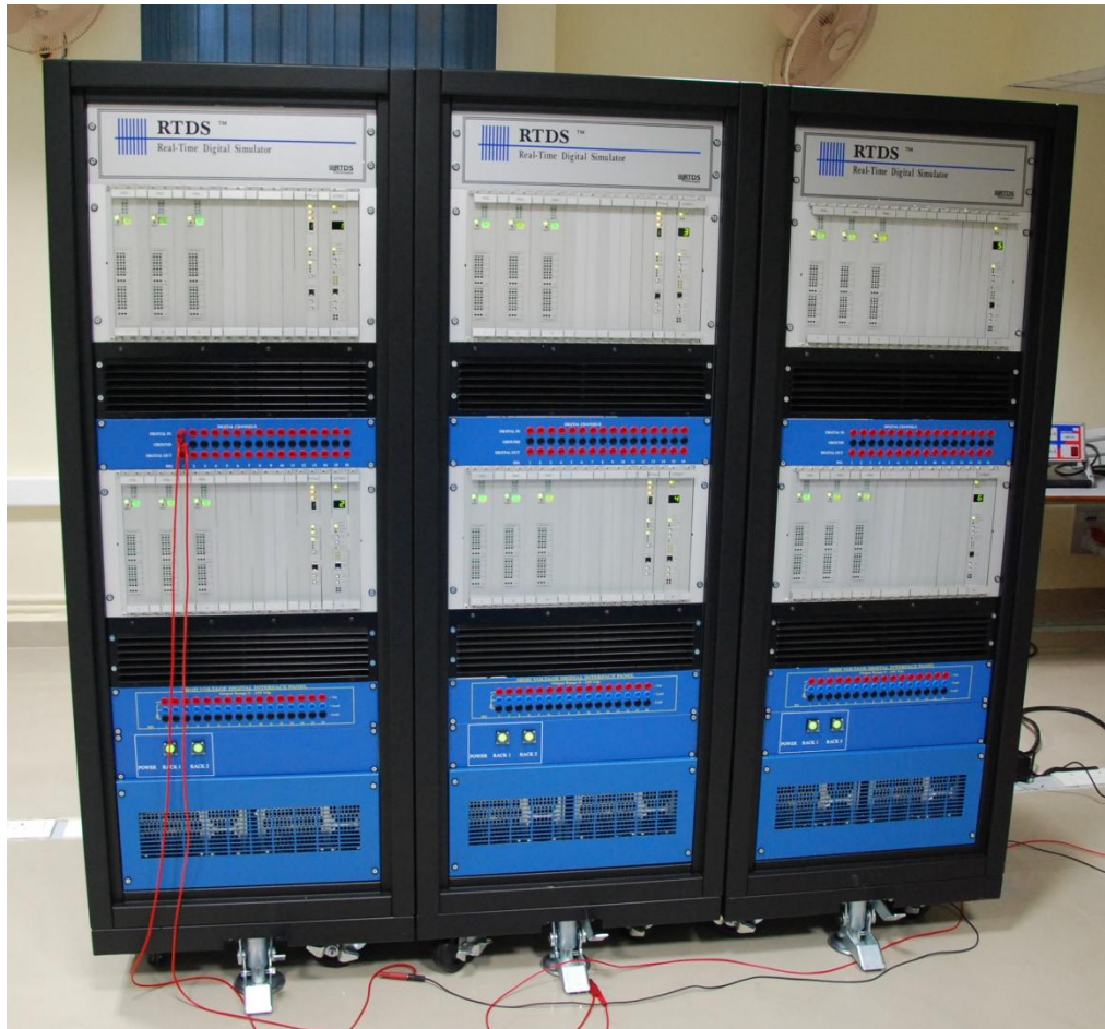
Εικόνα 3.1 Ψηφιακός εξομοιωτής πραγματικού χρόνου (RTDS)
