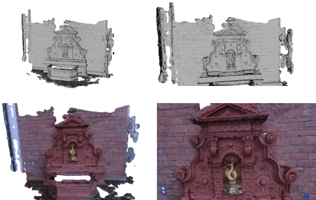
Σχήμα 6.26: Τελική ανακατασκευή της επιφάνειας, όπως προέκυψε από τον αλγόριθμο PSR
