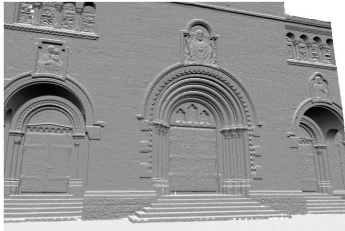
Σχήμα 3.12: Ανακατασκευασμένο μοντέλο με laser scanner. Από [216].
