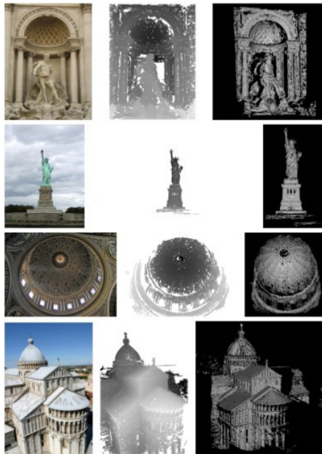
Σχήμα 3.3: Αριστερή στήλη: Εικόνες συνόλου δεδομένων. Μεσαία στήλη: Χάρτες βάθους. Δεξιά στήλη: Ανακατασκευασμένο μοντέλο. Από [78]
