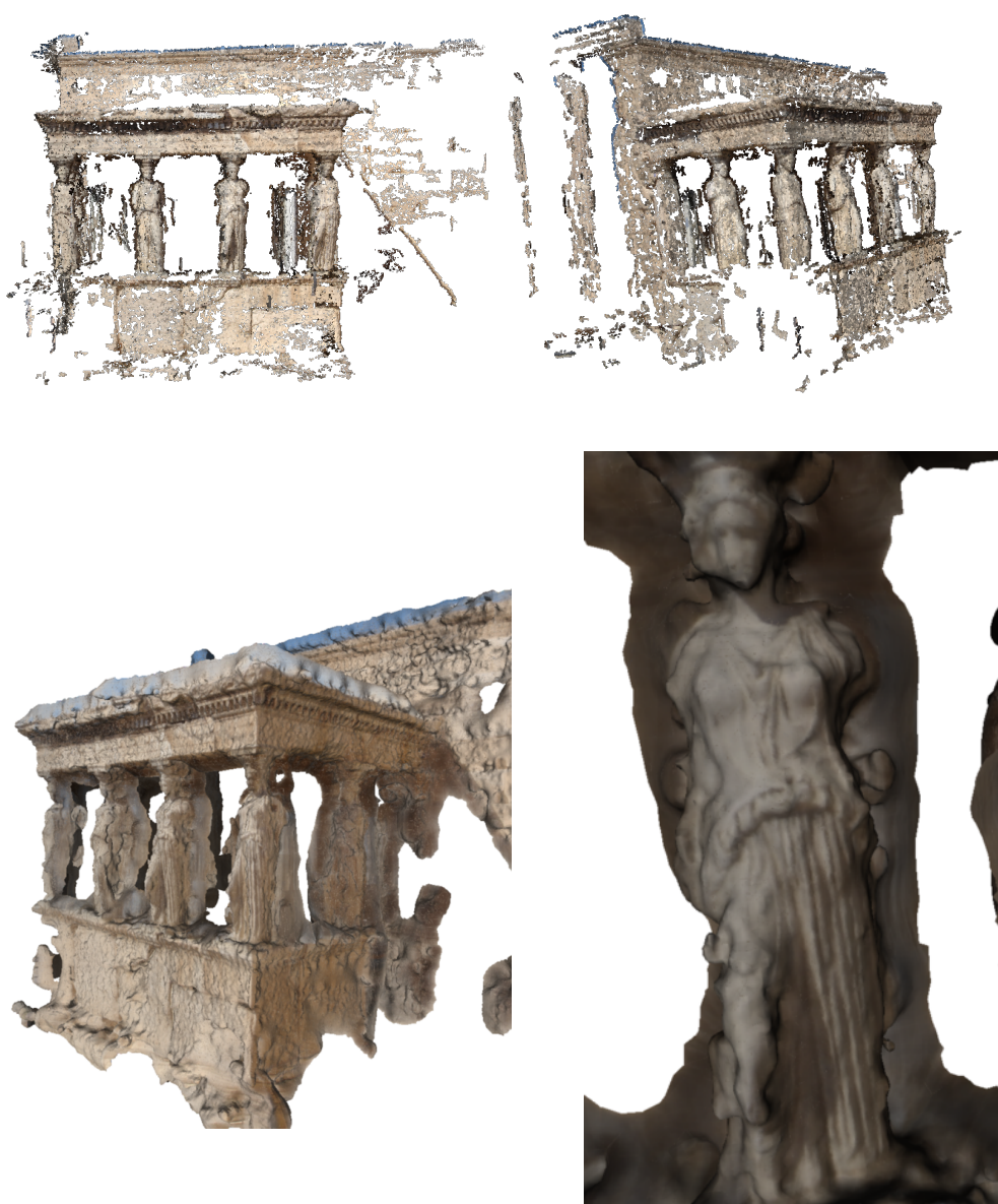
Σχήμα 6.27: Αποτελέσματα ανακατασκευής ( ως πύκνο σύννεφο σημείων και ως textured επιφάνεια ) για τις Καρυάτιδες.
