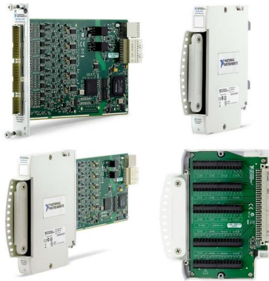
Σχήμα 2. 15: PXIe-4357 (πάνω-αριστερά), TB-4357 (πάνω-δεξιά), TB-4357 συνδεδεμένο στο PXIe-4357 (κάτω-αριστερά) και TB-4357 εσωτερική όψη (κάτω-δεξιά)
