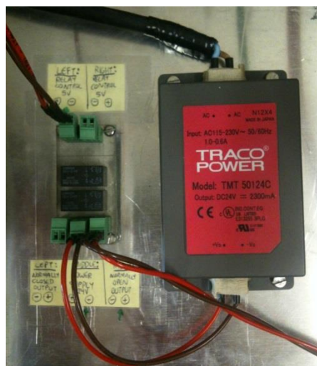
Σχήμα 2. 19: Πλακέτα ηλεκτρονόμου και εξωτερική τροφοδοσία για τη λειτουργία του φρένου
