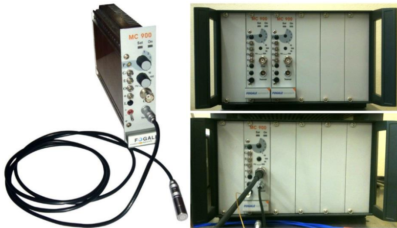
Σχήμα 2. 9: Fogale MCC-10 συνδεδεμένο στο MC900 (αριστερά) και διαθέσιμα modules (δεξιά)
