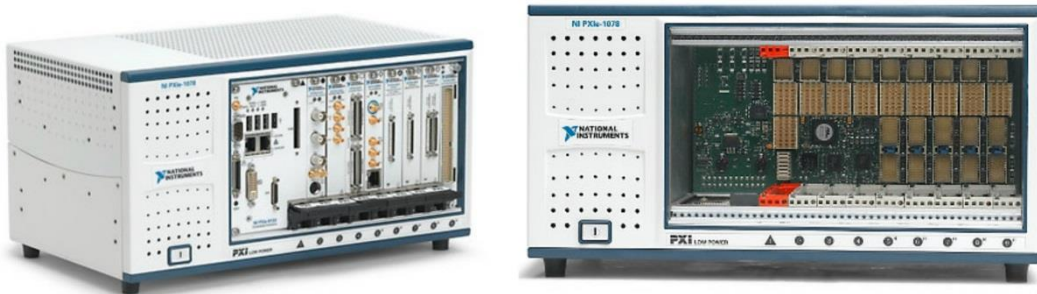
Σχήμα 2. 13: Γεμάτο και άδειο PXIe-1078 chassis
