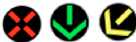
Εικόνα 5: Μεταβλητή σήμανση για τη ρύθμιση της κυκλοφορίας
