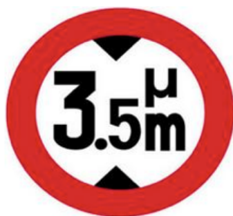
Εικόνα 2: Σταθερή σήμανση για μέγιστο επιτρεπόμενο ύψος οχήματος
