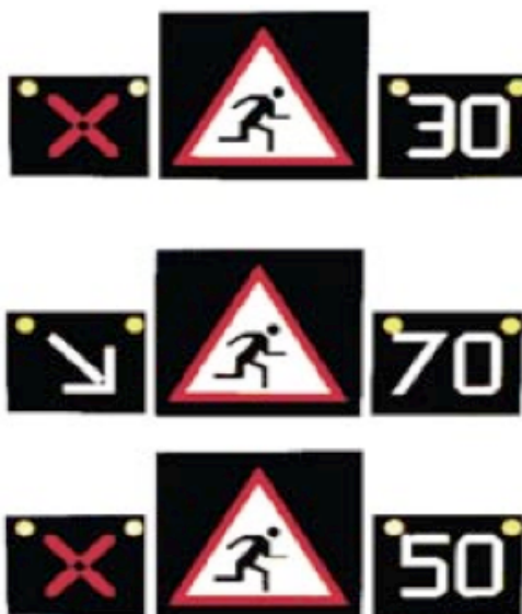
Εικόνα 9: Μεταβλητή σήμανση ρύθμισης κυκλοφορίας λόγω εκκένωσης διπλανού κλάδου της σήραγγας
