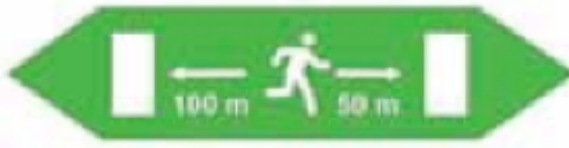
Εικόνα 8: Σταθερή σήμανση για απόσταση από εξόδους ασφαλείας
