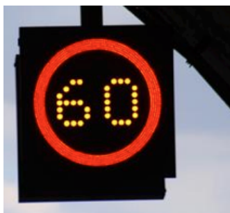
Εικόνα 3: Μεταβλητή σήμανση για όριο ταχύτητας
