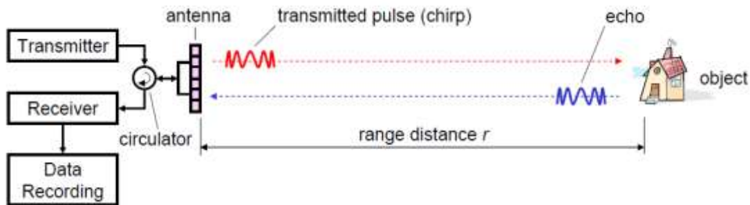
Εικόνα 1.4 Αρχή λειτουργίας συστήματος SAR Πηγή:www.dlr.de
