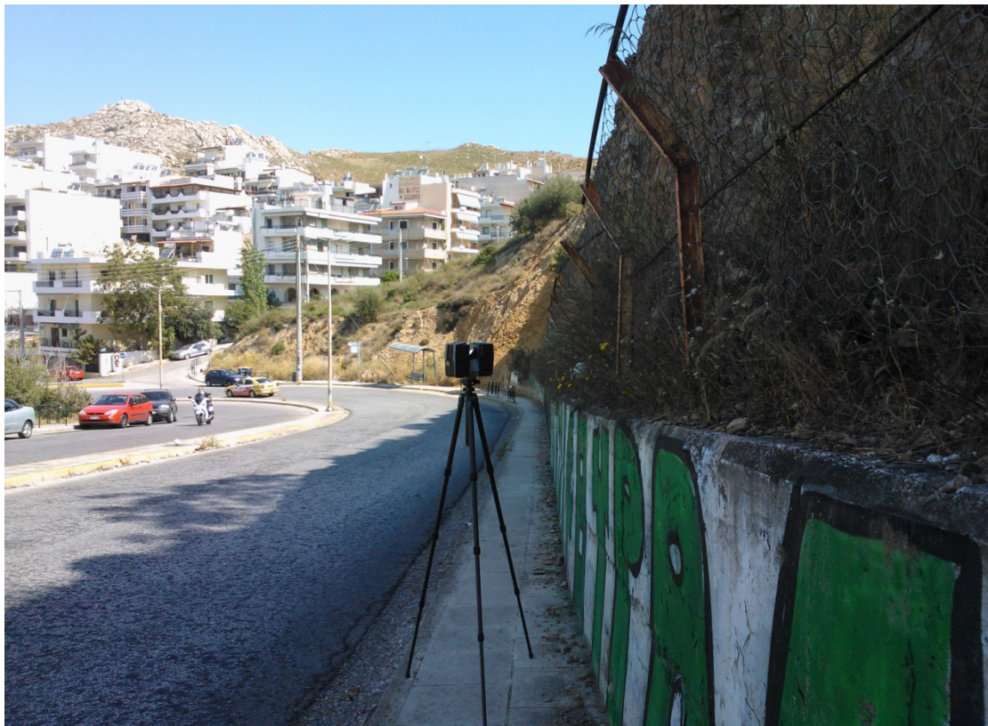
Εικόνα 13: Σαρωτής Faro Focus 3D στο πεδίο (Στάση 01).
