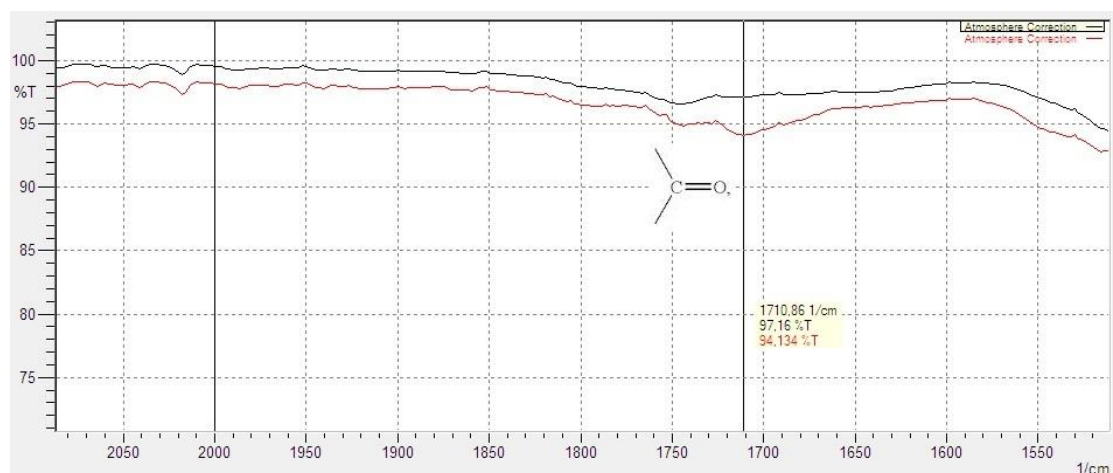
Διάγραμμα 16: Διαφοροποίηση στο φάσμα υπερύθρου της καθαρής και της οξειδωμένης ένωσης δεκαλίνης
