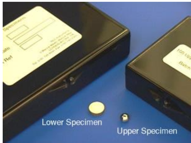
Εικόνα 8: Δοκίμια HFRR (Άνω και Κάτω δοκίμιο)
