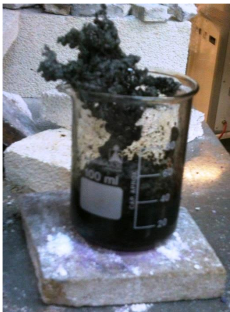
Σχήμα B1-2: Καταλύτης ο οποίος με την εφαρμογή θερμότητας το διάλυμα των αντιδραστηρίων αύξησε τον όγκο του
