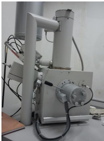
Σχήμα Β2-5: Η συσκευή SEM που χρησιμοποιήθηκε
