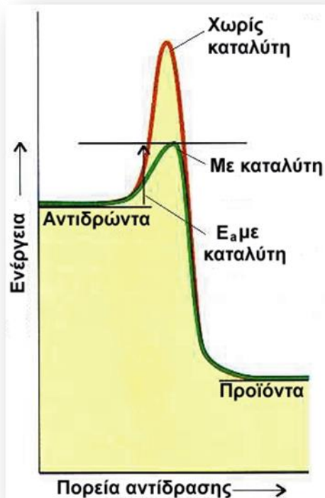
Σχήμα A2-1: Λειτουργία καταλύτη σε μια χημική αντίδραση
