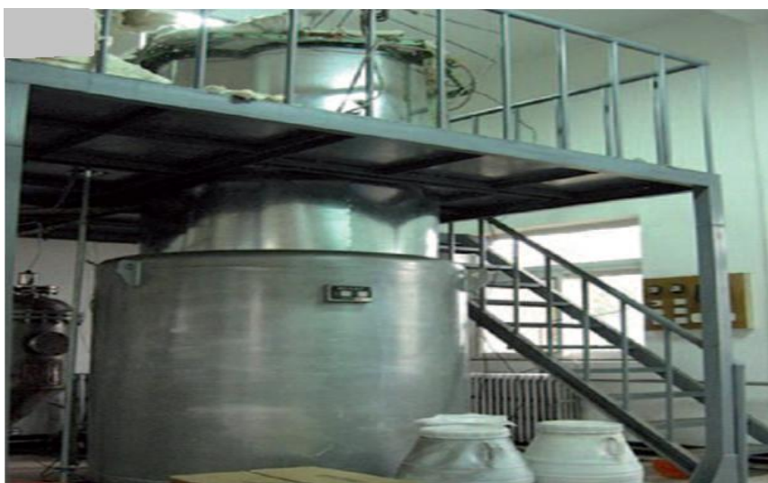
Εικόνα 22: Αντιδραστήρας CVD βιομηχανικού τύπου
