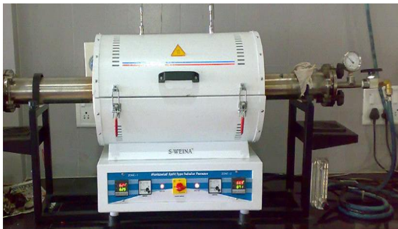
Εικόνα 32: Αντιδραστήρας με μεταλλικό σωλήνα
