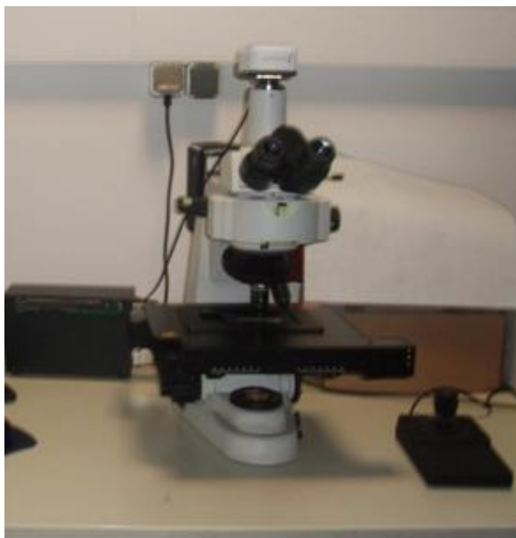
Εικόνα 3.2: Μικροσκόπιο με ηλεκτροκίνητη τράπεζα και χειριστήριο καθώς και έγχρωμη ψηφιακή κάμερα μικροσκοπίας στο Εργαστήριο Υγειονομικής Τεχνολογίας του ΕΜΠ.
