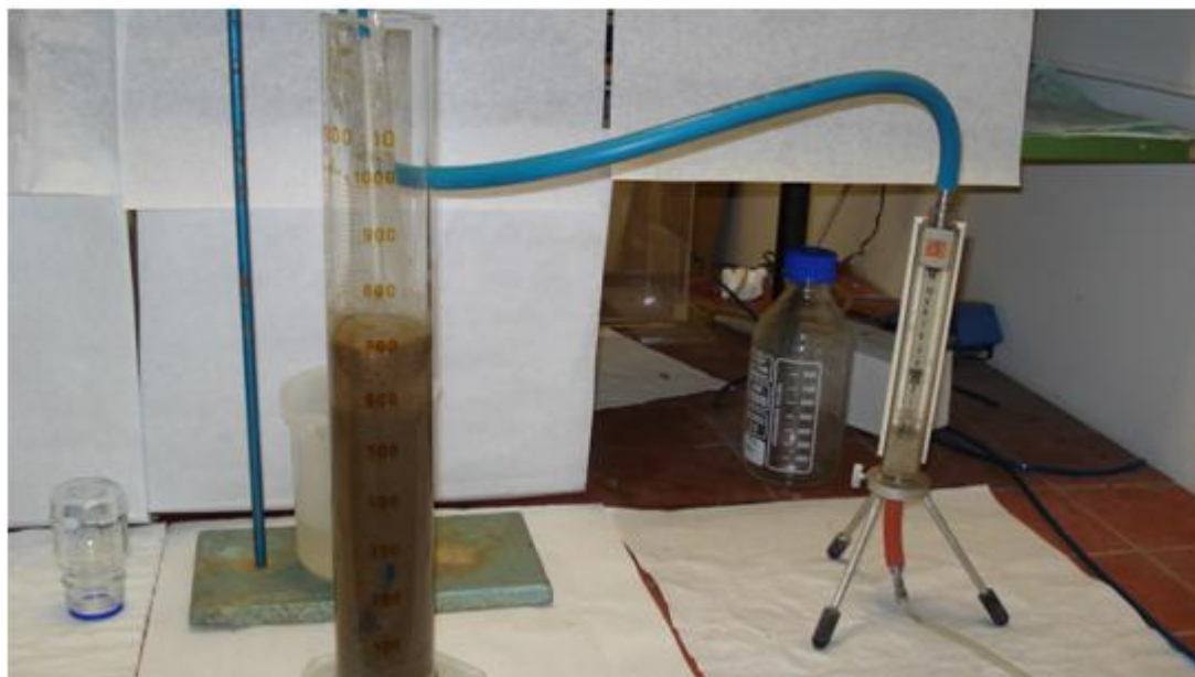
Εικόνα 3.42: Πειραματική διάταξη μέτρησης αφρισμού.
