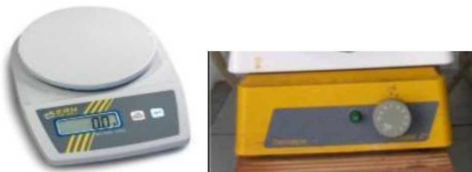
Εικόνα 3.39: Ζυγός στα αριστερά και μηχανικός αναδευτήρας στα δεξιά
