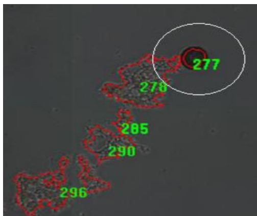
Εικόνα 3.29: Εφαρμογή της εντολής Set on/off είναι απαραίτητη στο παραπάνω παράδειγμα για την διαγραφή της φυσαλίδας αέρα που νοείται από το πρόγραμμα λανθασμένα ως κροκίδα, λόγω της χρωματικής ομοιότητας με τις υπόλοιπες κροκίδες και προσημάνθηκε με τον αριθμό 277. ( Πηγή: Βασιλική Χιουρέα, Ιούλιος 2013).
