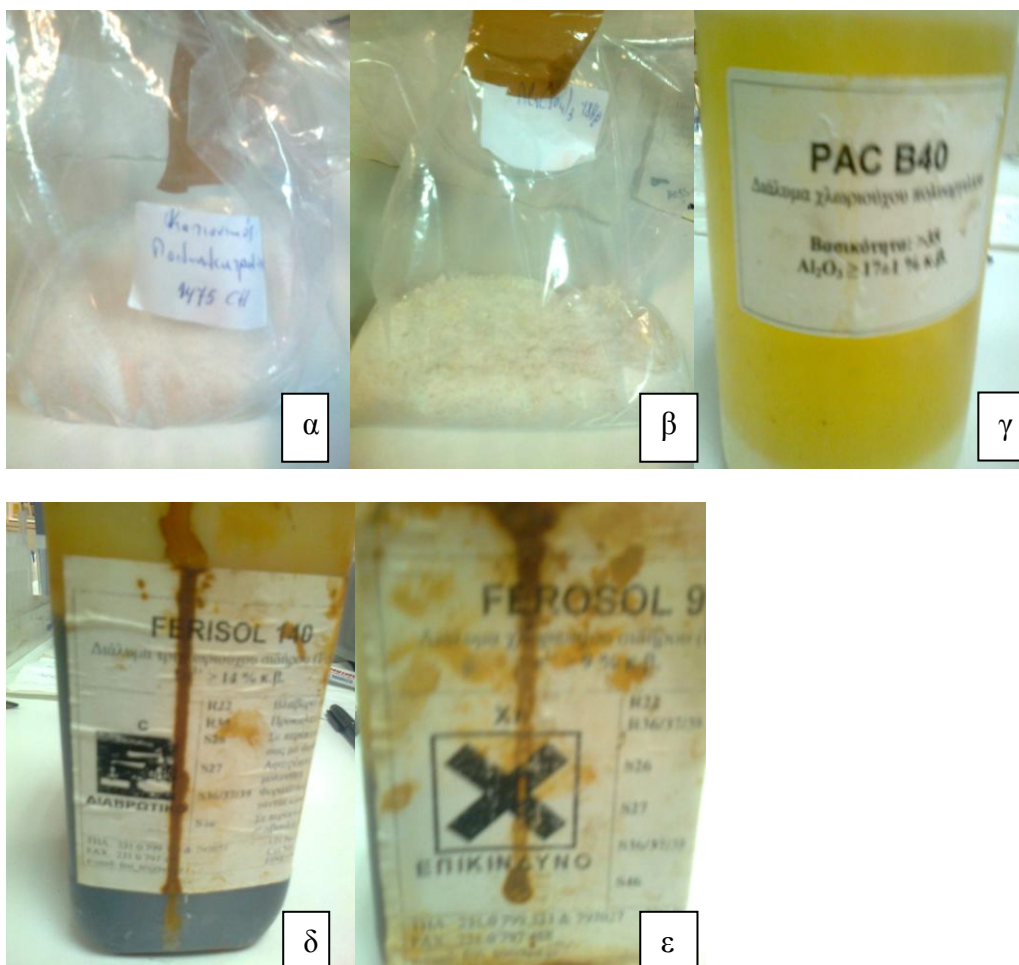
Εικόνα 3.41: Κροκιδωτικά: (α) κατιονικός πολυηλεκτρολύτης, (β) θειικό αργίλιο, (γ) χλωριούχο πολυαργιλικό υδροξείδιο χαμηλής βασικότητας, (δ) τρισθενής χλωριούχος σιδήρος, (ε) χλωριούχος υποσίδηρος.
