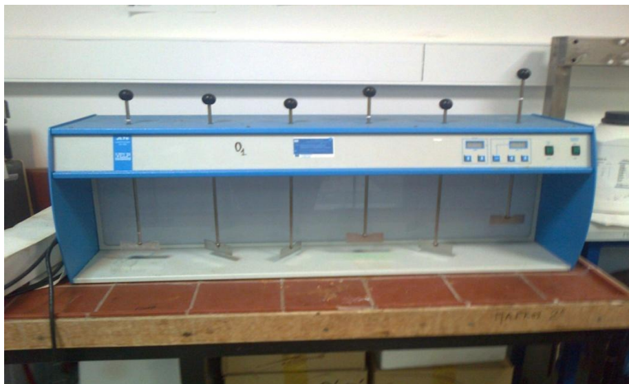
Εικόνα 3.40: Συσκευή ανάδευσης που χρησιμοποιήθηκε για την καλή ανάμειξη του διαλύματος των κροκιδωτικών. Η συσκευή αυτή διαθέτει δυνατότητα ρύθμισης των στροφών ανάδευσης και χρονόμετρο.
