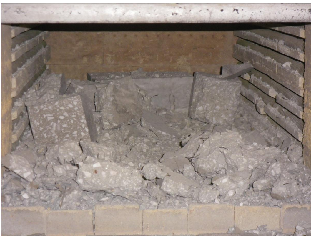
Εικόνα 4-3: Εικόνα δοκιμίων μετά από έψηση σε θερμοκρασία 500 °C
