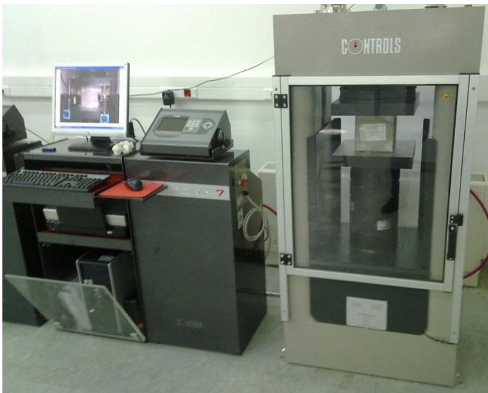
Εικόνα 5-13: Σερβοϋδραυλική μηχανή φόρτισης
