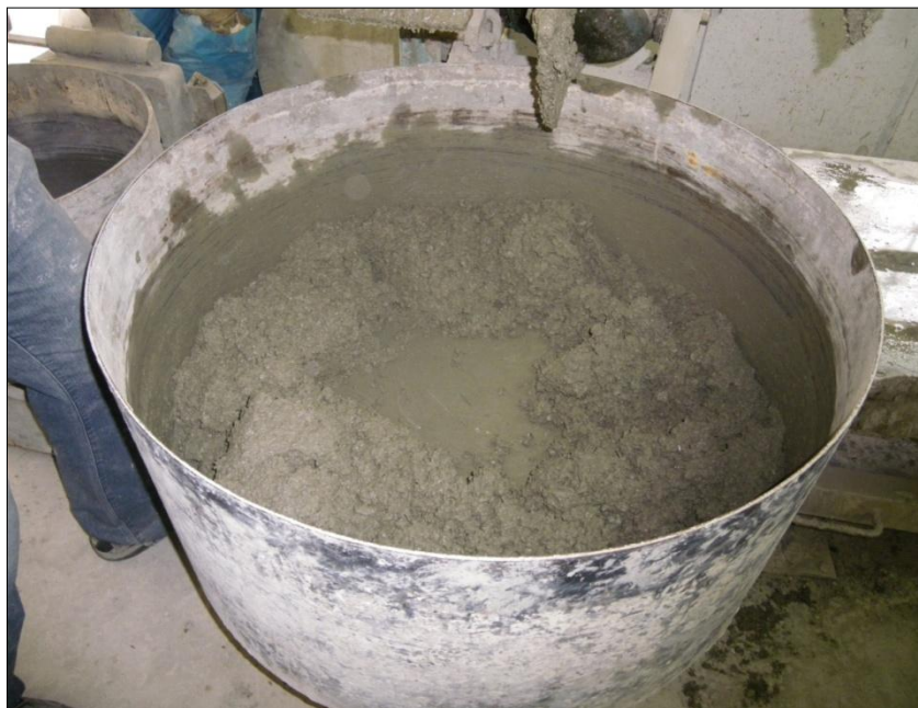
Εικόνα 5-6: Τελικό προϊόν σκυροδέτησης στον αναδευτήρα
