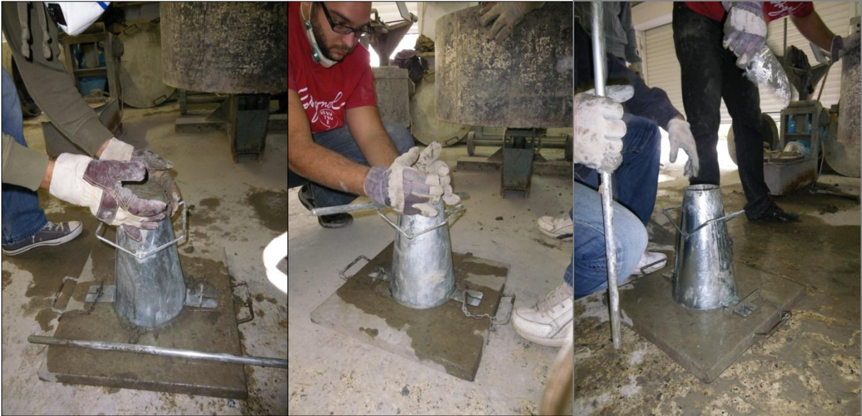
Εικόνα 5-7: Διαδικασία δοκιμής κάθισης
