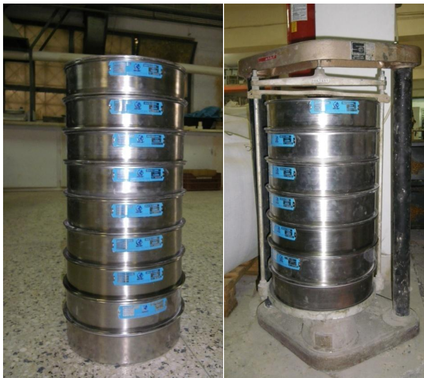
Εικόνα 5-3: Χρησιμοποιούμενα κόσκινα και συσκευή κοσκίνισης
