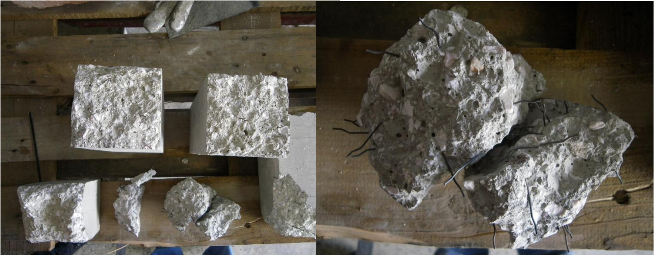
Εικόνα 5-12: Εικόνα δοκιμίων μετά από εκρηκτική αποκόλληση
