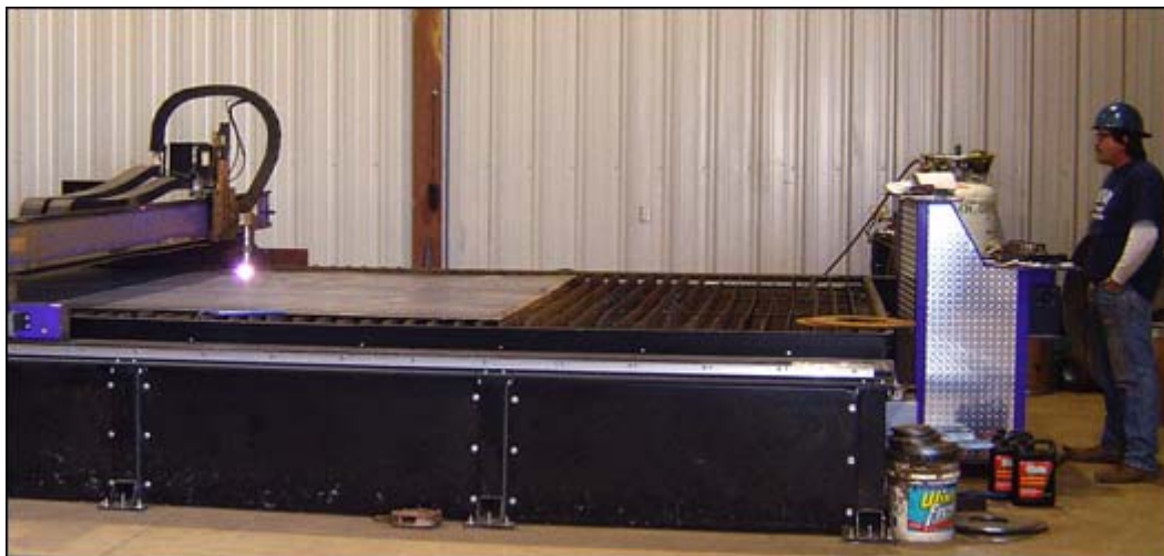
Εικόνα 1.5 Κοπή μεταλλικού ελάσματος στο εργοστάσιο σε μηχάνημα CNC plasma
