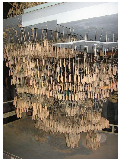
Εικόνα 1.1.4 Αναποδογυρισμένο φυσικό προσομοίωμα της Colonia Guell, Μουσείο Sagrada Família
